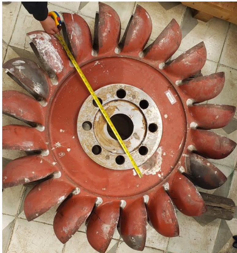
Figura. 2.13 Rodete de turbina pelton de la central "Illuchi N°2".
