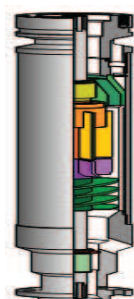
FIGURA 2.5 SEPARADOR DE GAS
