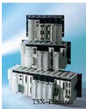
Figura # 1.13 Estructura modular
