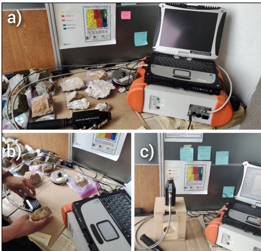
Figura 26. Fotografías del procedimiento del uso del TerraSpec (ASD), a) Accesorios, b) Toma de espectros en roca, c) Toma de espectros en sedimentos. Fuente: Propia autoría.
