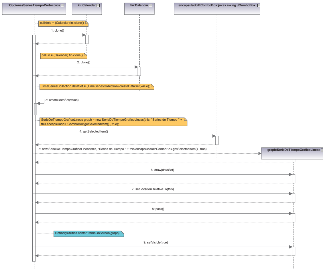
Gráfico 3.157 Diagrama de secuencia para obtener una gráfica de series de tiempo
