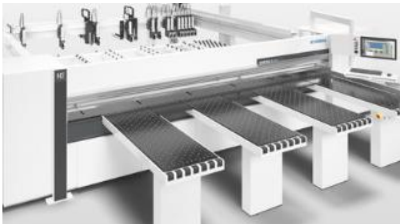
Figura 20 Cortadora CNC de tableros de fibrocemento. Fuente: (Elaboración propia)
