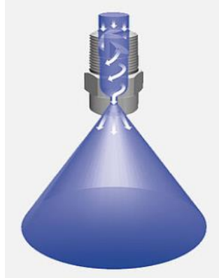
Figura 31. Pulverización cono lleno (Fuente: LECHLER)
