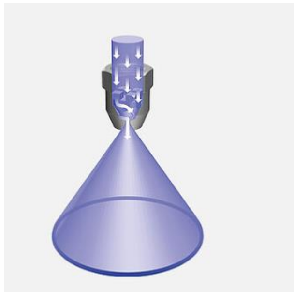
Figura 33. Pulverización con hueco
