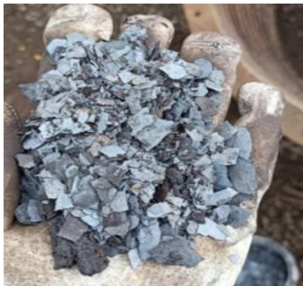
Figura 4. Óxido de Hierro (Cascarilla o Calamina)
