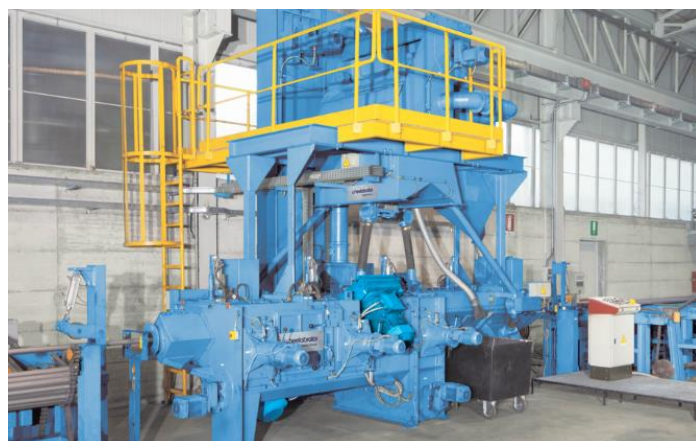
Figura 12. Máquina para eliminar palanquilla modelo Wheelabrator (Fuente: Wheelabrator)
