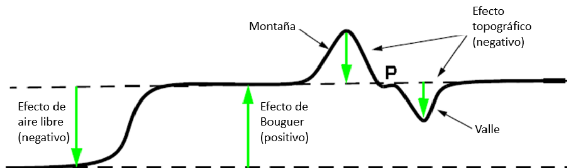
Figura 15. Efectos de aire libre, Bouguer y topográfico. (Modificado de: Seigel, 1995)
