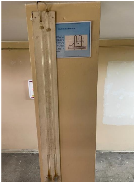
Fotografía 3.4 Tubo piezométrico usado para la medición del caudal en el canal hidrodinámico del laboratorio docente de hidráulica de la FICA.
