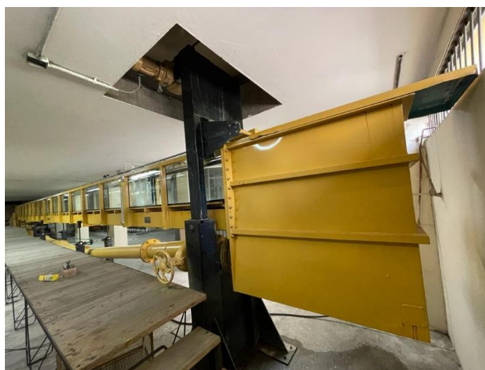
Fotografía 3.1 Canal hidrodinámico o de pendiente variable del Laboratorio Docente de Hidráulica de la Facultad de Ingeniería Civil y Ambiental'.
