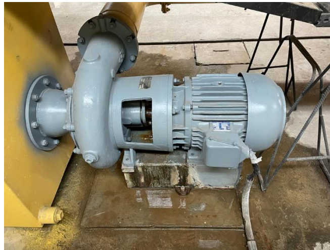
Fotografía 3.2 Sistema de bombeo del canal hidrodinámico de pendiente variable del Laboratorio docente de Hidráulica de la Facultad de Ingeniería Civil y Ambiental .
