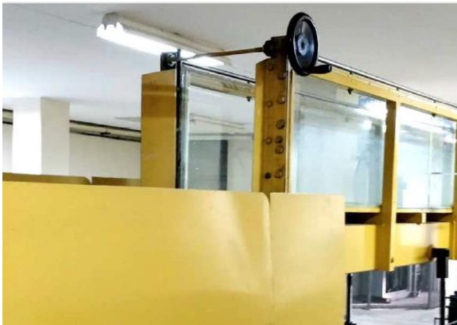
Fotografía 3.6 Compuerta plana vertical utilizada en el experimento.
