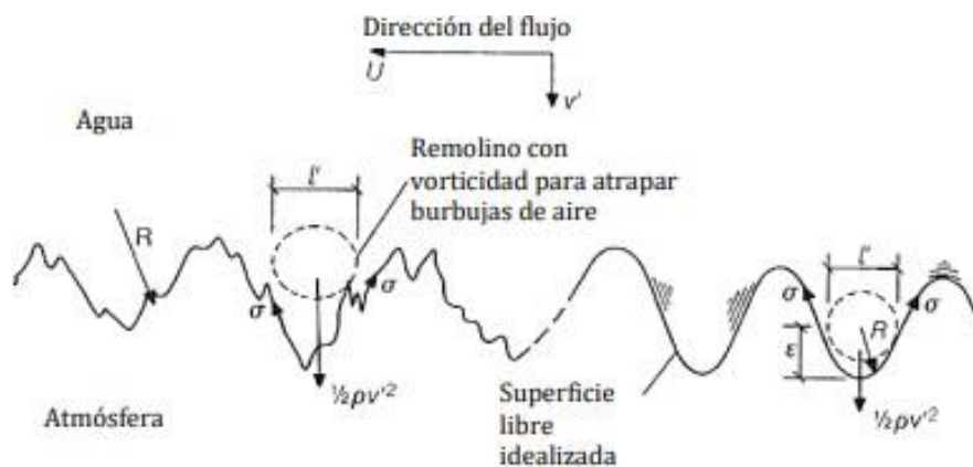
Figura 4. Parámetros físicos en las ondulaciones de la superficie libre (Fuente: Ortega, 2022)
