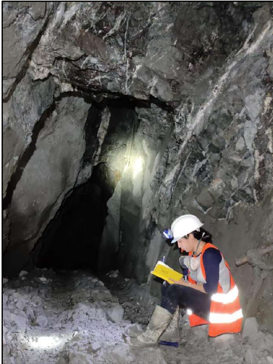
Figura 3.14. Mapeo Geológico en galería de la veta Jorupe – Tres Reyes. Se observa y describe litología, estructuras, mineralización, alteraciones y se plasman los datos en la libreta de campo.
