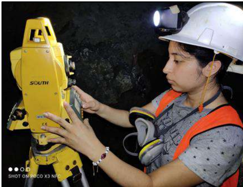
Figura 3.2. Toma de puntos con estación total en galerías interior mina.
