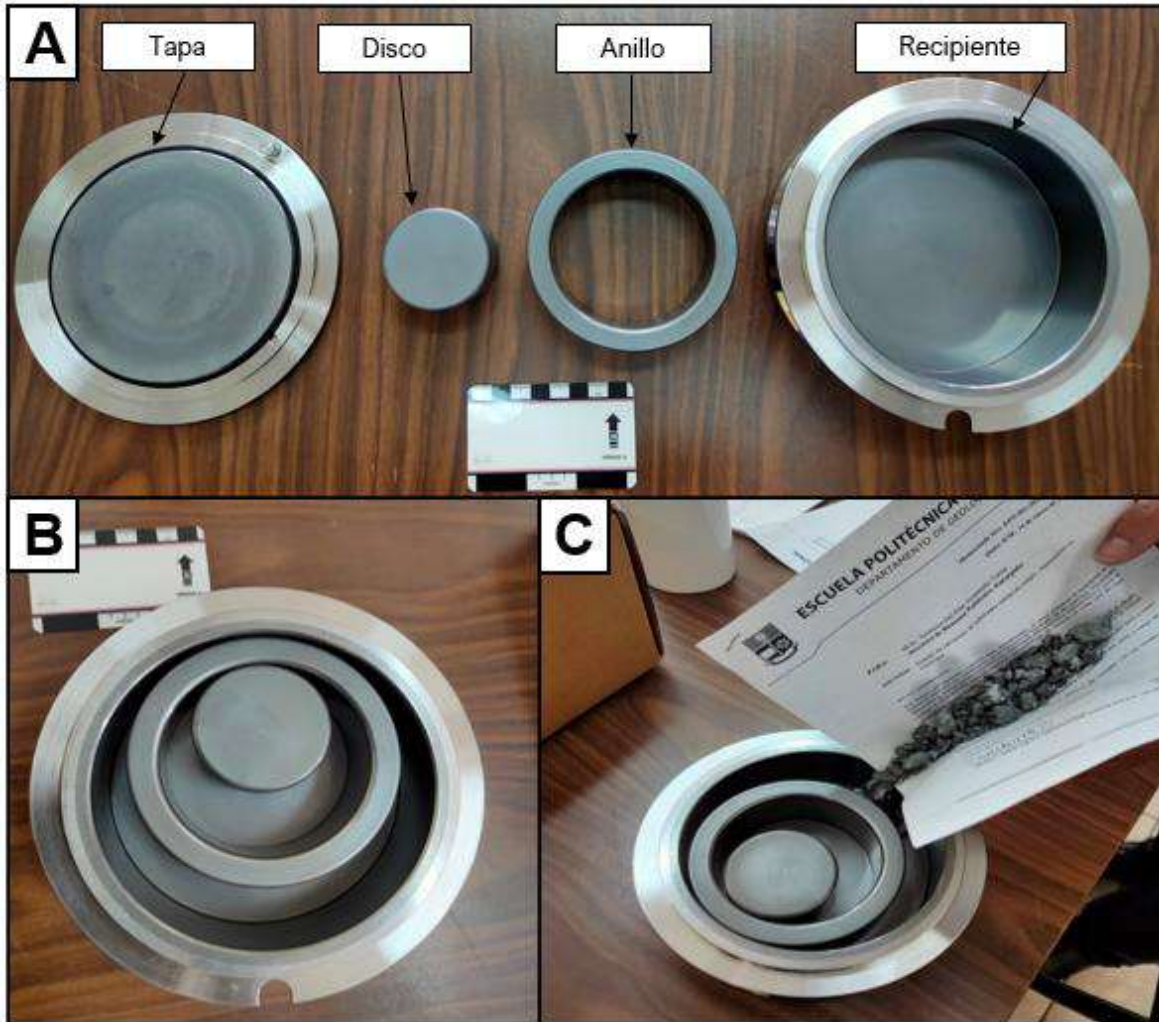
Figura 3.26. Juego de molienda de carburo de tungsteno de 100 ml (marca Retsch). A. Partes del juego de molienda; B. Forma correcta de colocar el juego de molienda; C. Espacio adecuado para colocar la muestra triturada.
