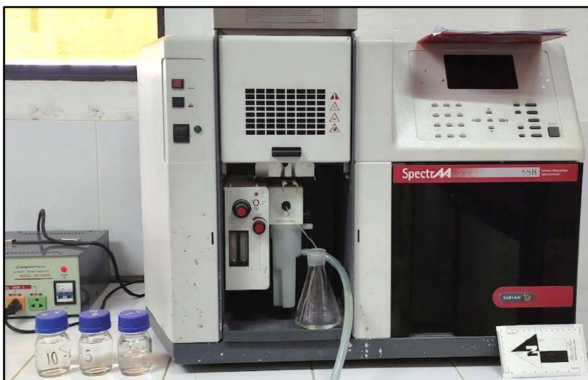
Figura 3.37. Equipo de Espectrometría de absorción atómica marca Varian modelo SpectraAA 55B del Laboratorio Químico y Metalúrgico de la Empresa Minera Oroconcent S. A.
