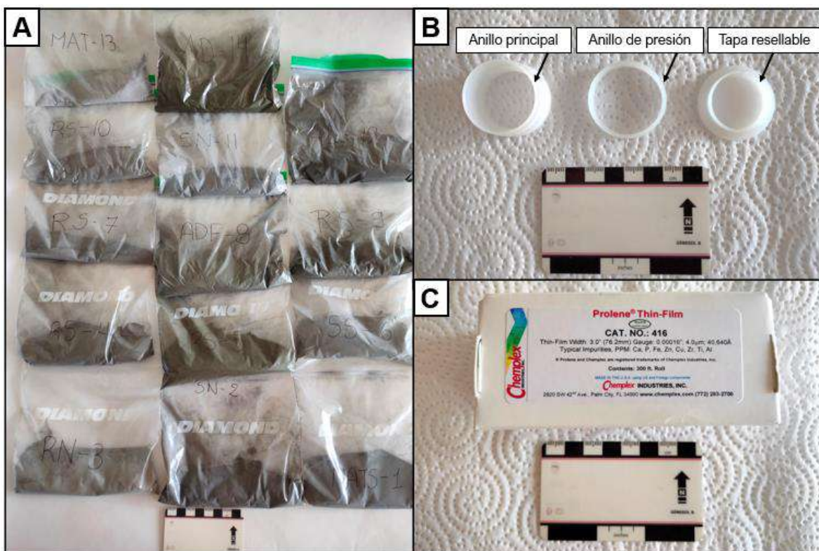
Figura 3.29. Material XRF para colocar las muestras molidas. A. Muestras empaquetadas y etiquetadas; B. Partes del anillo de presión modelo 1340 marca Chemplex; C. Prolene (plástico especial para XRF) marca Chemplex.
