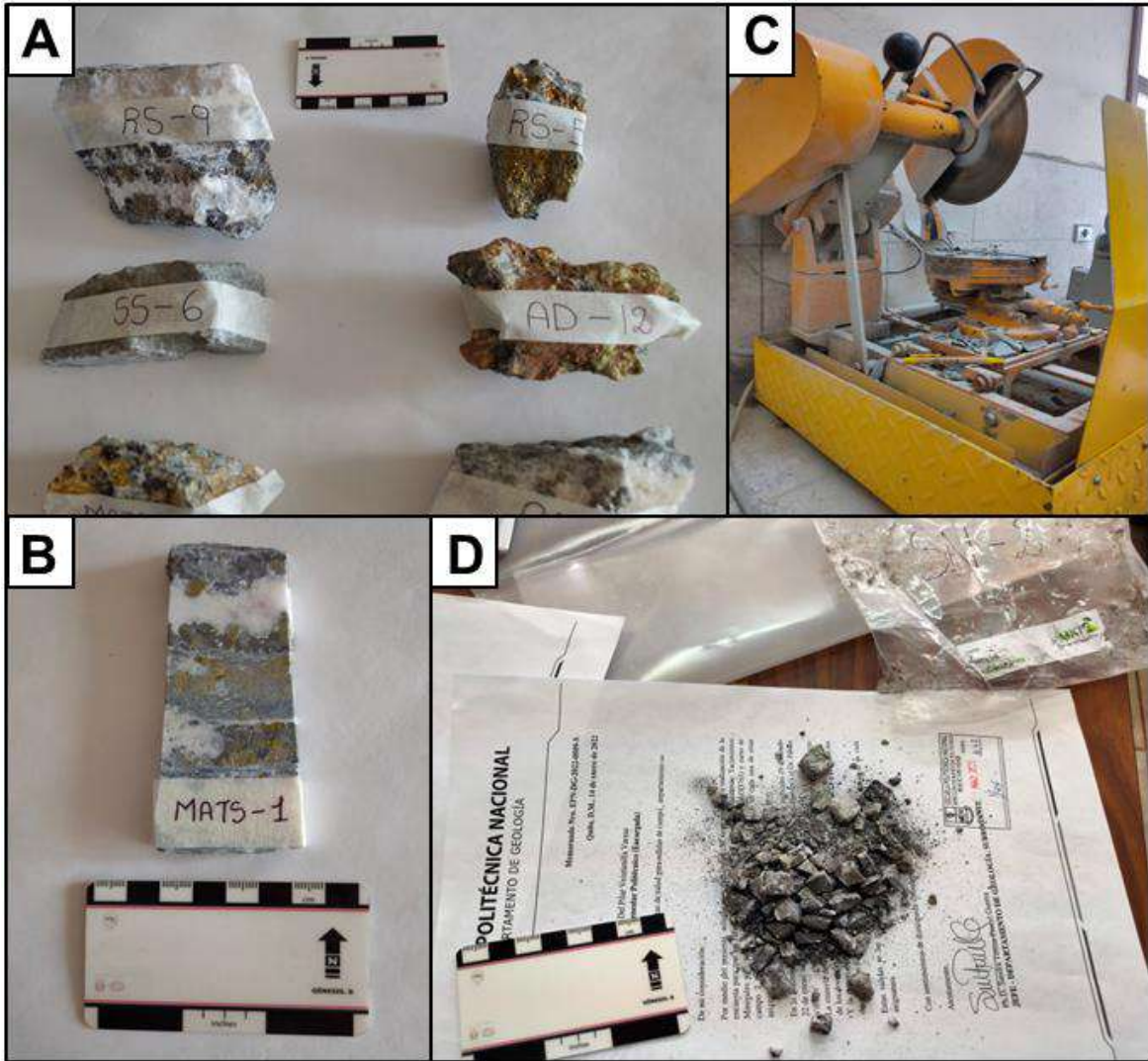
Figura 3.25. Proceso inicial de preparación de muestras. A. Etiquetado de las rocas; B. Corte de las rocas en secciones; C. Cortadora INGRAM-WARD 400U; D. Trituración manual de las rocas.
