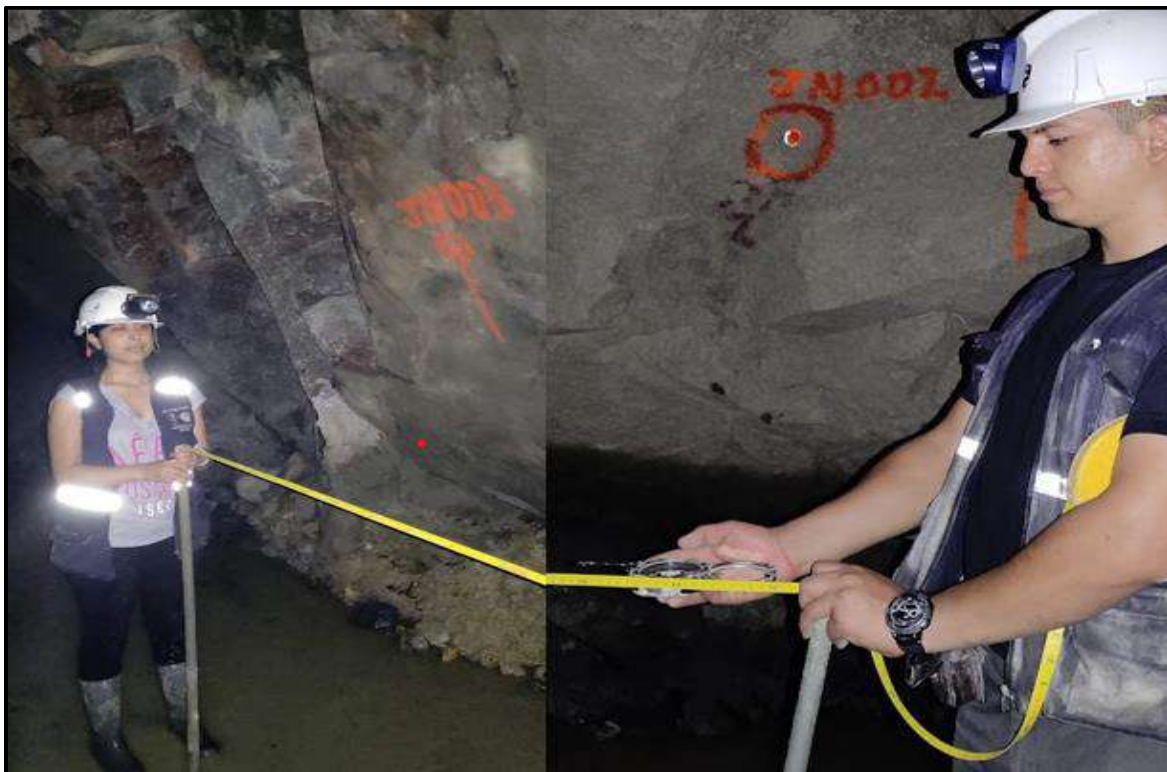
Figura 3.4. Ilustración del método Cinta-Brújula en interior mina.
