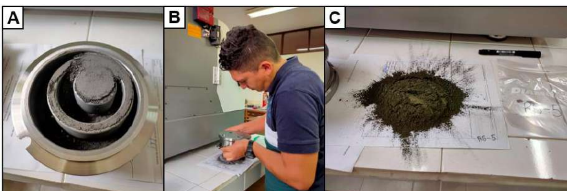
Figura 3.28. Resultado obtenido del molino de discos vibratorio. A. Muestra molida; B. Extracción de la muestra del juego de molienda; C. Empaquetamiento de las muestras molidas.
