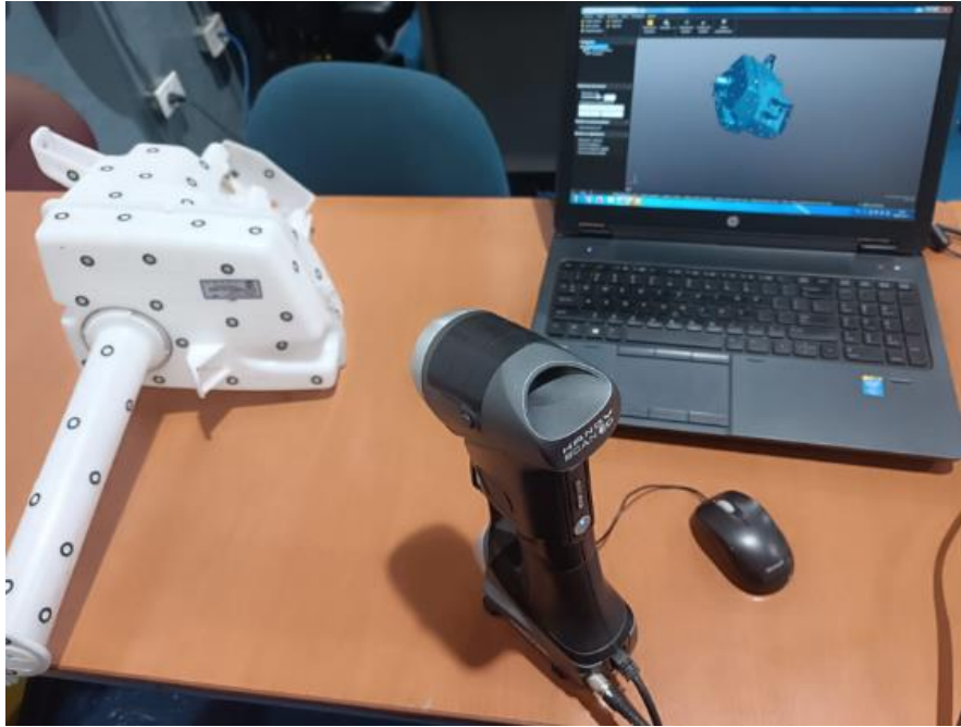
Figura 2.5. Escáner 3 de detección de puntos sobre una superficie. (Fuente: Propia)
