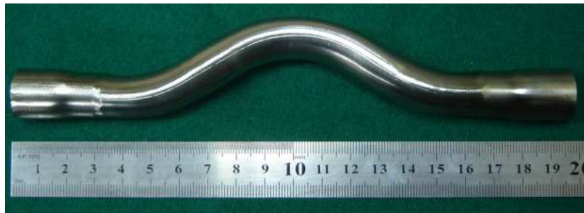
Figura 3.9 Puente para unión a traslape.
