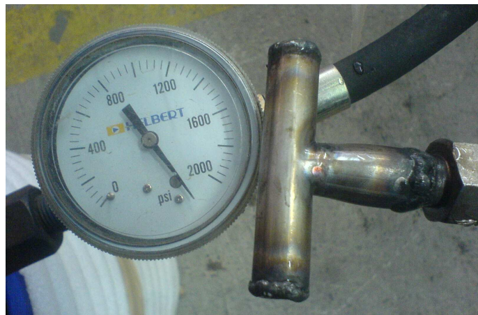
Figura 4.4 Probeta sometida a presión máxima
