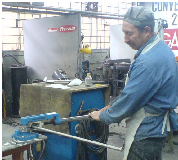
Figura 3.2 Conformado del codo, fuerza en la palanca
