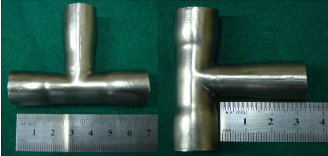
Figura 3.8 Tee Igual terminada, para unión a traslape
