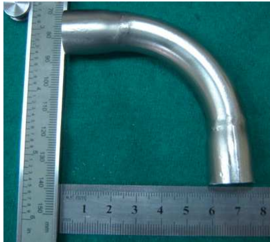
Figura 3.3 Codo 90° terminada, para unión a traslape
