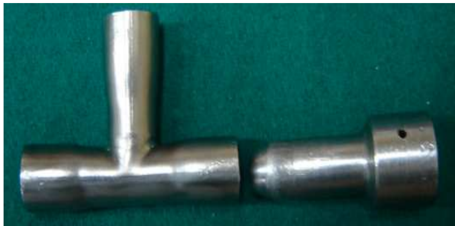
Figura 3.7 Expansión de los extremos de la Tee
