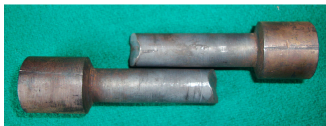
Figura 2.25 Punzón para expansión (trabajan conjuntamente con la esfera)
