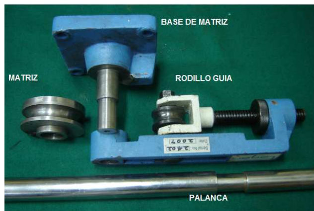
Figura 2.17 Partes de una dobladora por compresión
