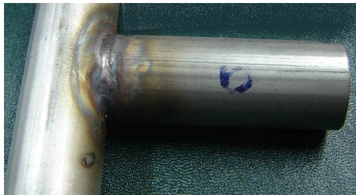
Figura 3.6 Soldadura de la base y la ramificación (Proceso TIG)
