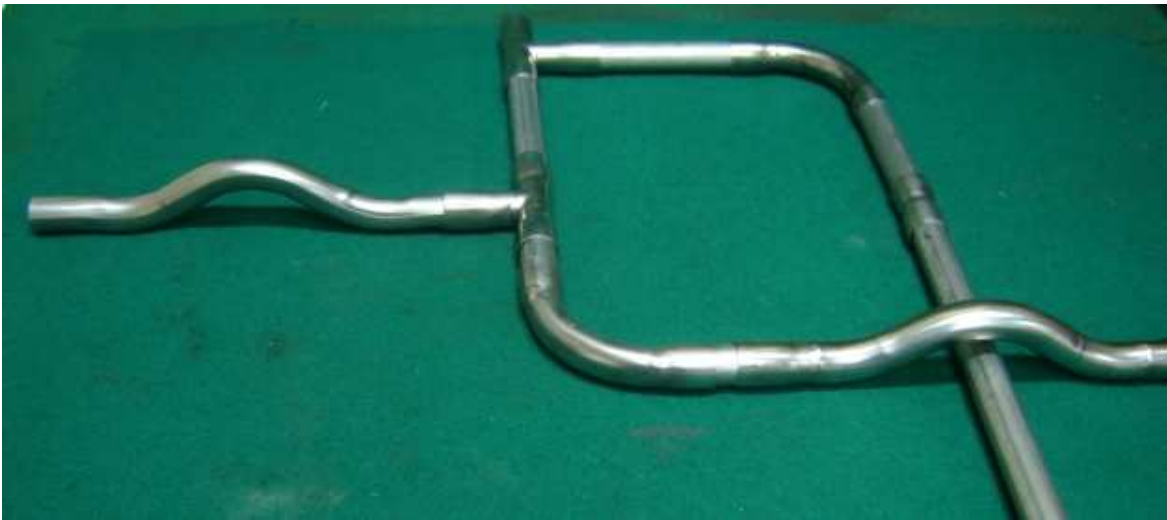
Figura 4.10 Sistema de conducción formado por accesorios en acero inoxidable 304.
