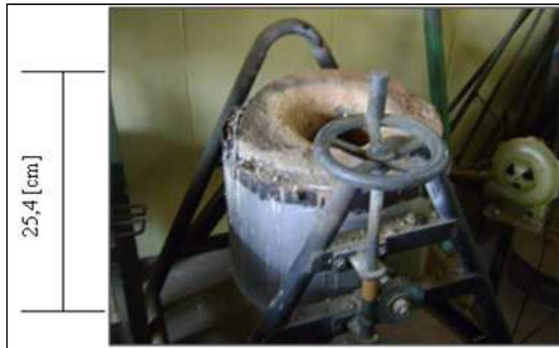
Figura 2.7. Fotografía horno de crisol a gas, empleado en la fusión de tarjetas de circuitos impresos
