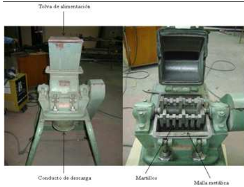
Figura 2.3. Fotografía de la vista exterior e interior del molino de martillos utilizado para la reducción de tamaño
