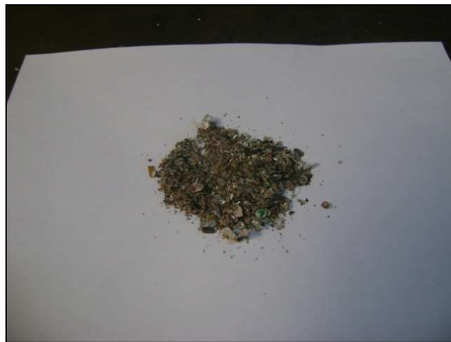
Figura 2.4. Fotografía de la tarjeta luego de la reducción de tamaño con molino de martillos
