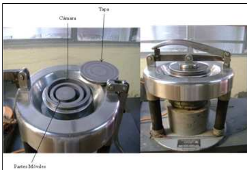
Figura 2.5. Fotografía de la vista exterior e interior del pulverizador utilizado para la reducción de tamaño
