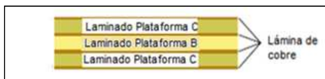
Figura 1.6. Estructura de una tarjeta de circuitos impresos multicapa (Mitzner, 2009)
