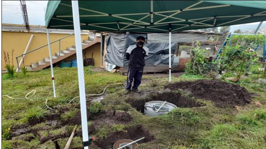
Figura 3.7. Infiltrómetros de doble anillo instalados con agua en su interior y un techo sobre ellos para evitar la alteración de condiciones iniciales
