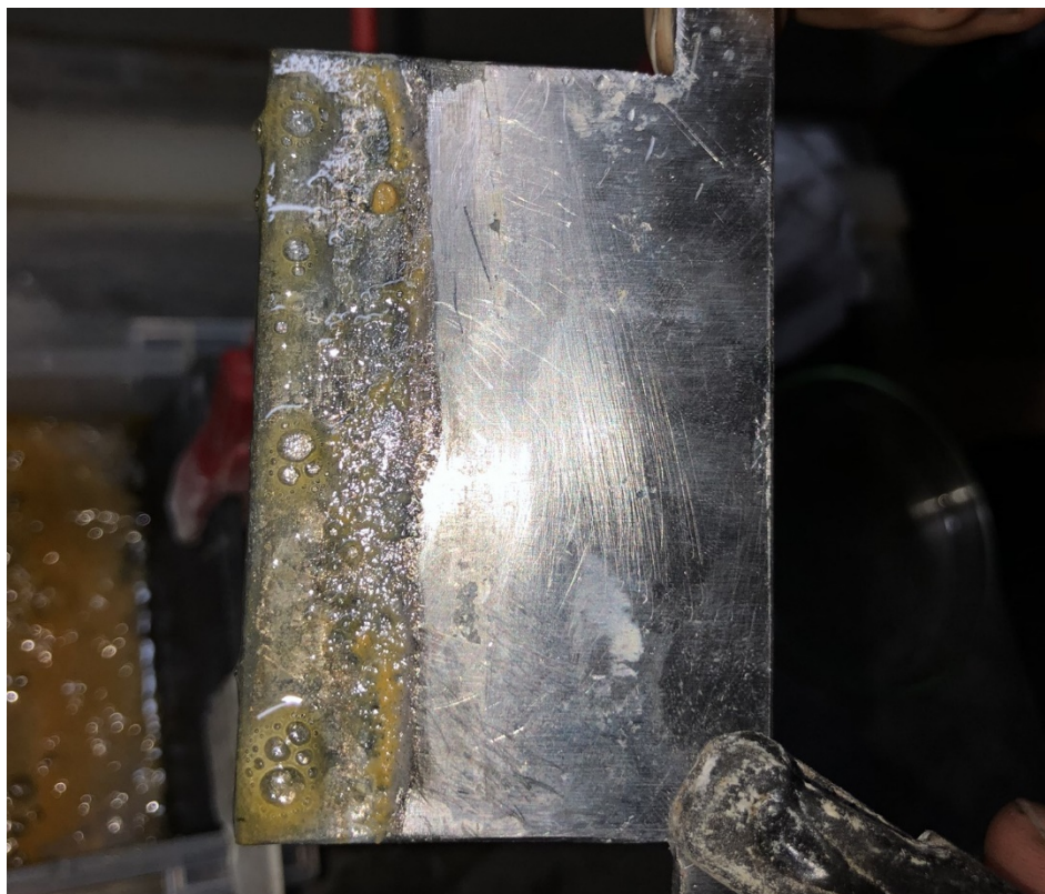
Figura 3.1.7. Burbujas presentes durante la electrodeposición en el cátodo
