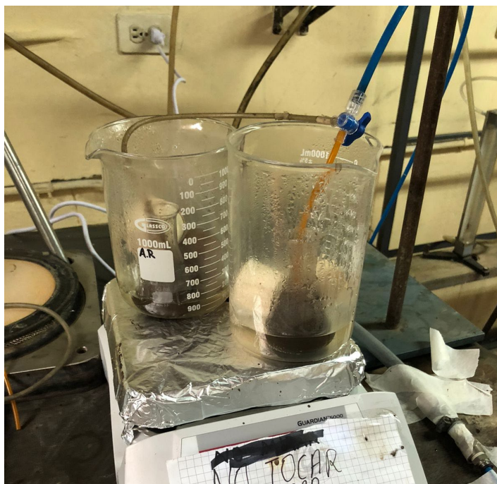
Figura 2.1. Ensayo de lixiviación utilizando aire como agente oxidante
