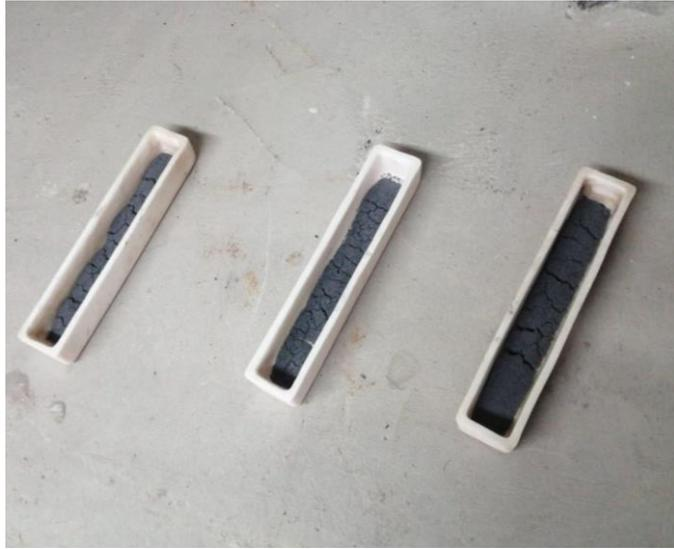
**Figura 5.7** Ferrita de cobalto recubierta calcinada para eliminación de orgánicos.
