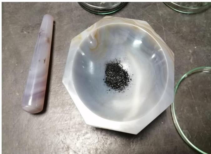
**Figura 5.3** Mortero de agata junto con ferrita de cobalto sintetizado por vía hidrotermal.
