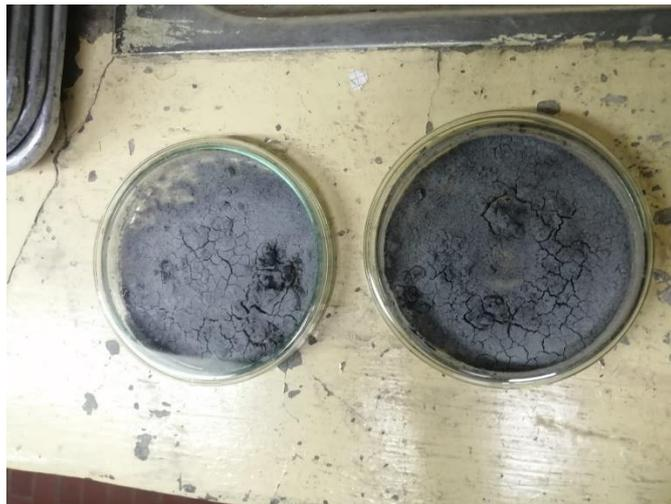
**Figura 5.6** Ferrita de cobalto recubierta de una capa densa de sílice y mesoporosa de silicalita de titanio.
