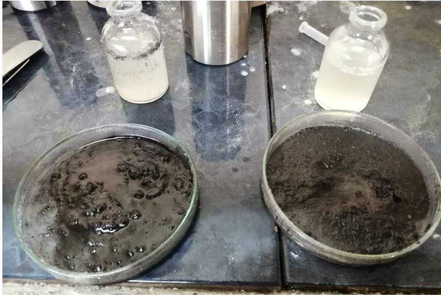
**Figura 5.5** Síntesis sol-gel de capa densa y mesoporosa, remoción de sobrenadante.
