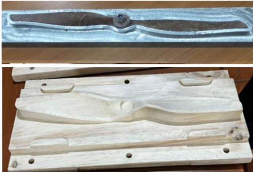
Figura 3.9 Molde de aluminio parte superior y Molde de madera parte inferior
