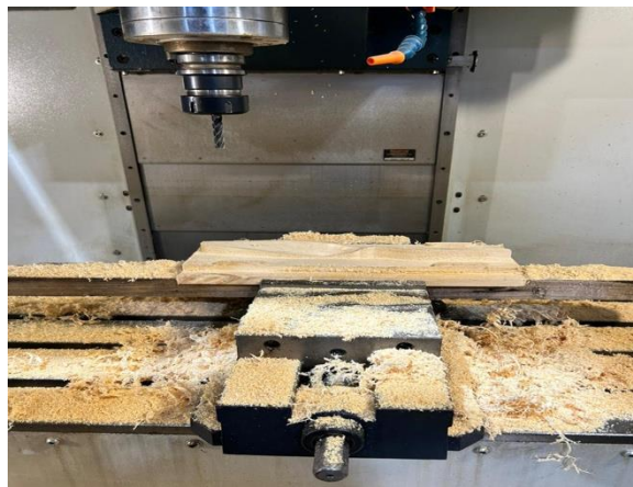
Figura 2.5 Proceso de maquinado por CNC del molde.
