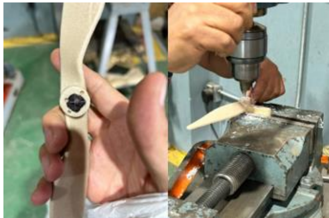
Figura 2.12 Perforación en el centro del tambor de las propelas.
