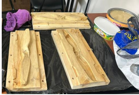
Figura 2.8 Colocación de cera desmoldante sobre el molde
