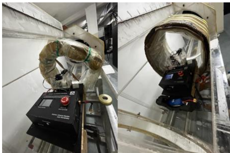
Figura 2.14 Recubrimientos de seguridad dentro del túnel de viento.
