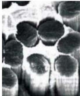
Figura 1.2 Microfotografía obtenida por microscopía electrónica de barrido de la superficie de fractura de una aleación plata-cobre, reforzada con fibras de carbono.
