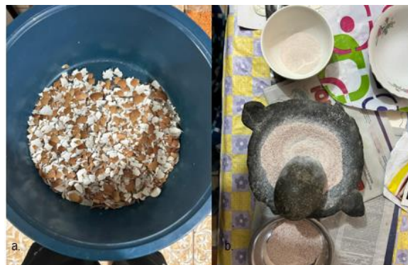
Figura 2.7 Proceso de pulverización de la cáscara de huevo. a.) Cáscara de huevo, b.) Polvo de cáscara de huevo
