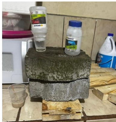
Figura 2.10 Proceso de compresión del molde con adoquines de 10 [kg]
