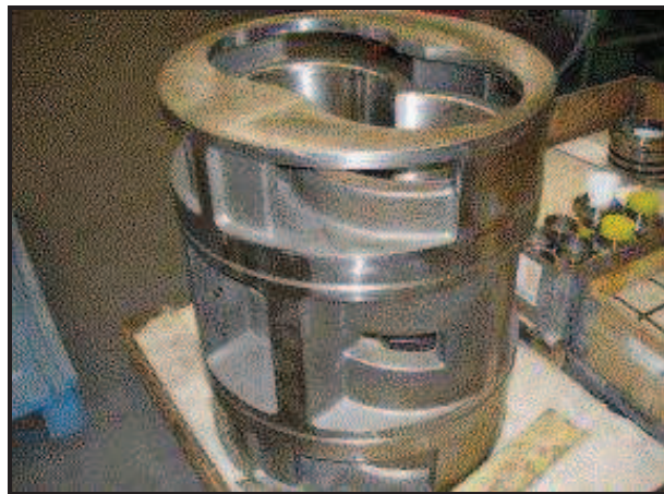
Figura No 3.15. Típico liner reemplazable
