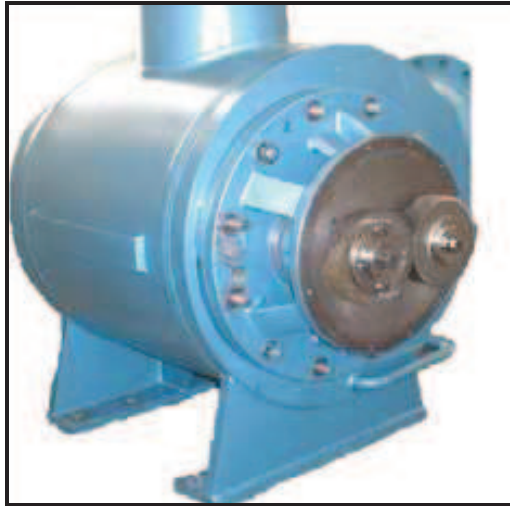
Figura No 3.36. Foto de engranajes de la bomba multifásica
