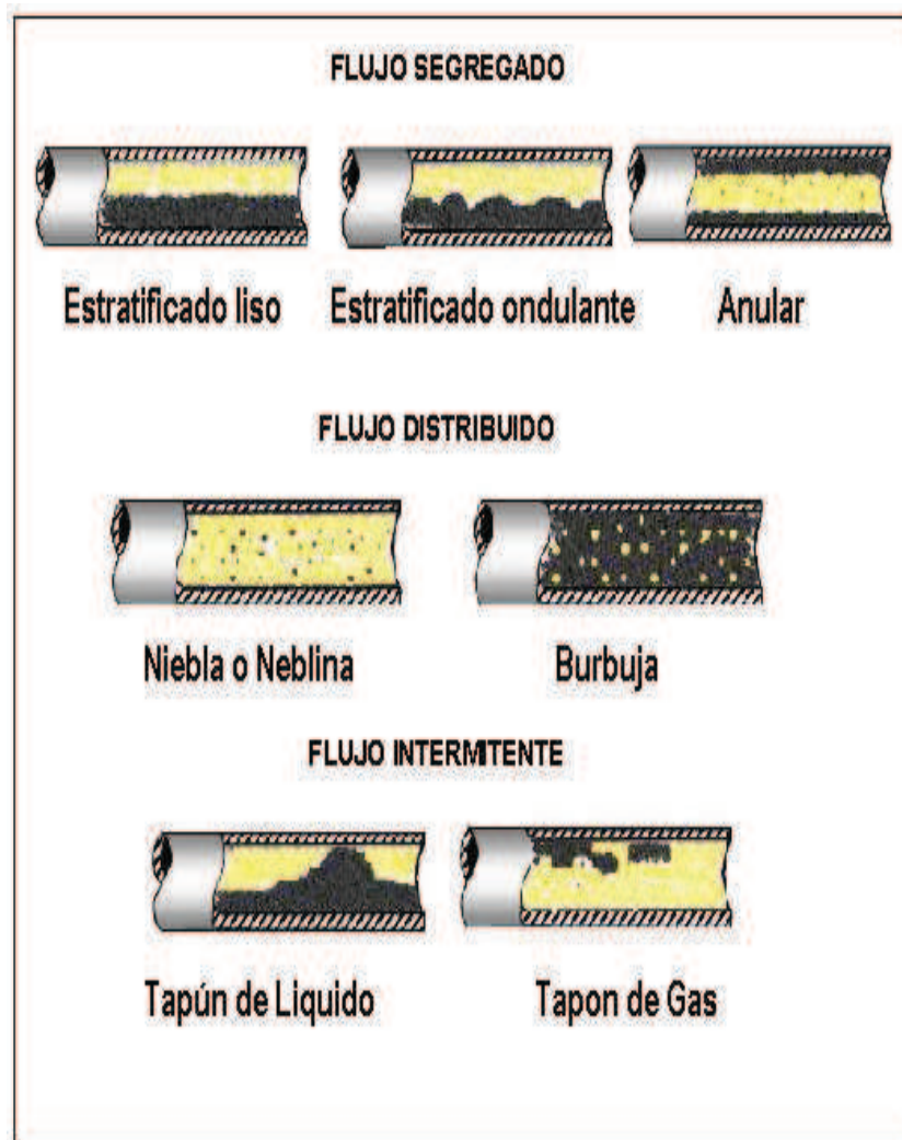
Figura No 3.1. Patrones de flujo en tuberías horizontales (Beggs y Brill)
