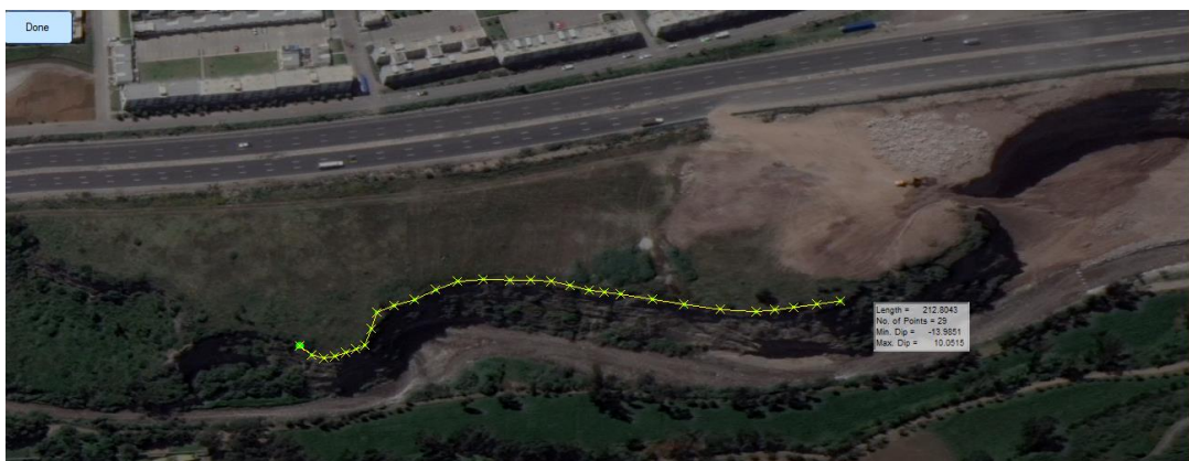
Figura 38: Medida del deslizamiento 2017.
