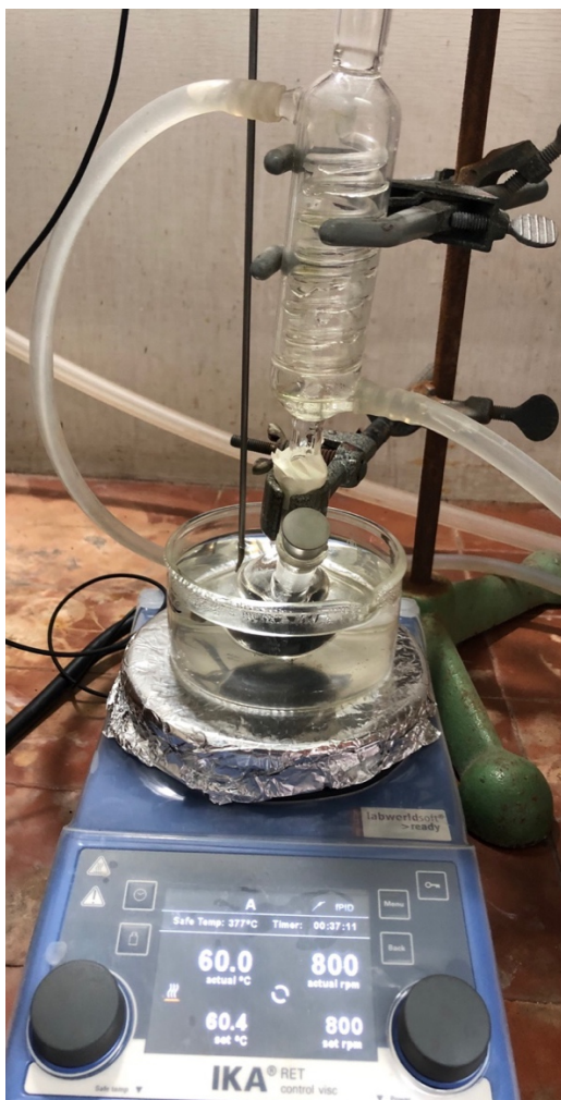
Figura 2.1 Sistema de reacción usado en los ensayos catalíticos.
