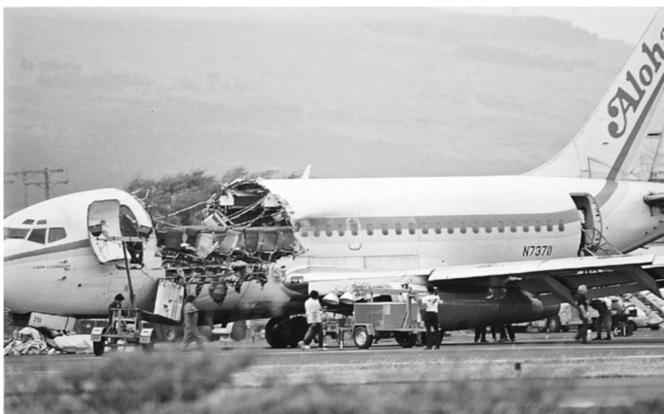
**Figura 2. 1** Fallas por fatiga en un fuselaje de avión.
