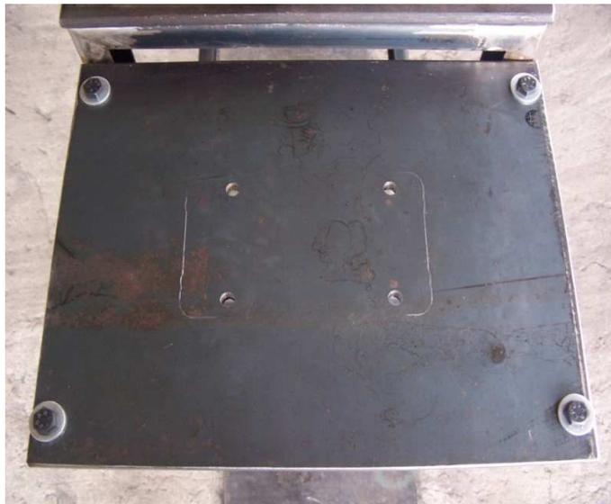
**Fotografía F. 2** Placa del motor sobre el bastidor
