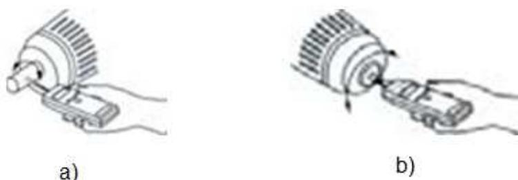
**Figura 4. 8** Forma de medición: a) Óptica y b) Con contacto.
