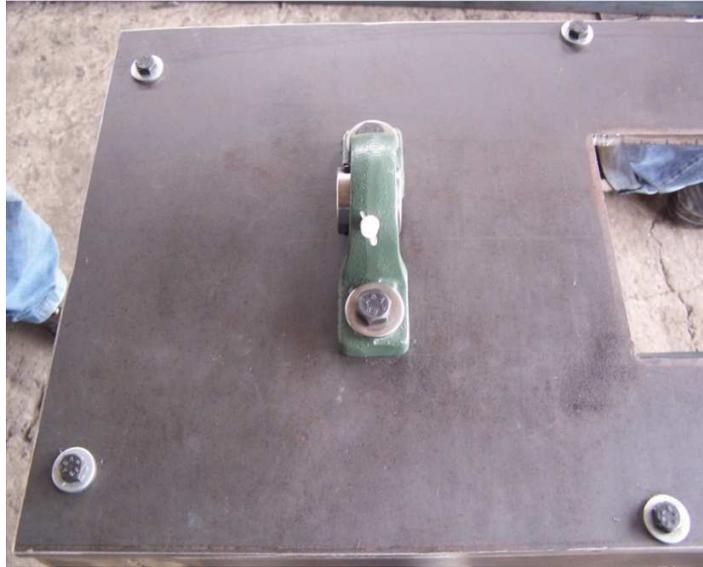
**Fotografía F. 3** Montaje de una chumacera sobre la placa principal
