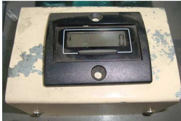
**Figura 1. 16** Contador de ciclos digital
