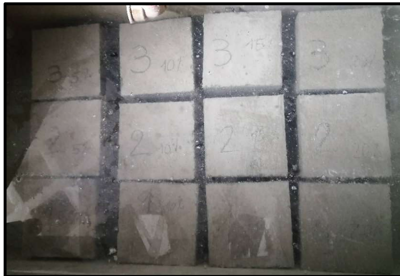
Figura 21. Cámara de curado
