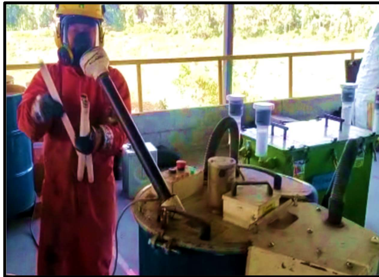
Figura 4. Destrucción de luminarias
