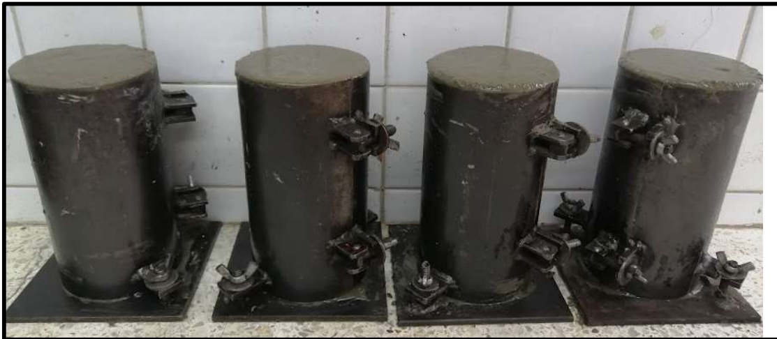
Figura 20. Fundición de testigos de hormigón
