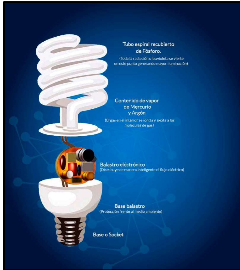
Figura 8. Funcionamiento de un foco ahorrador
