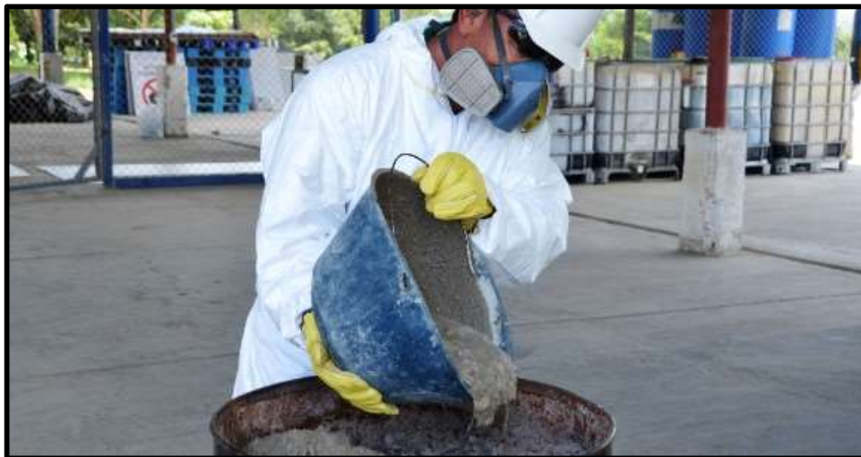
Figura 15. Adición de compuestos químicos para estabilización de residuos
