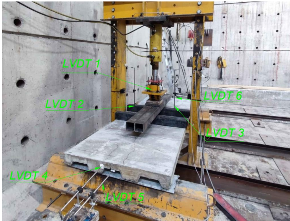
Figura 2.11. Ubicación de los transductores de desplazamiento lineal LVDT
