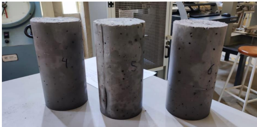
Figura 2.6. Cilindros antes del ensayo de compresión
