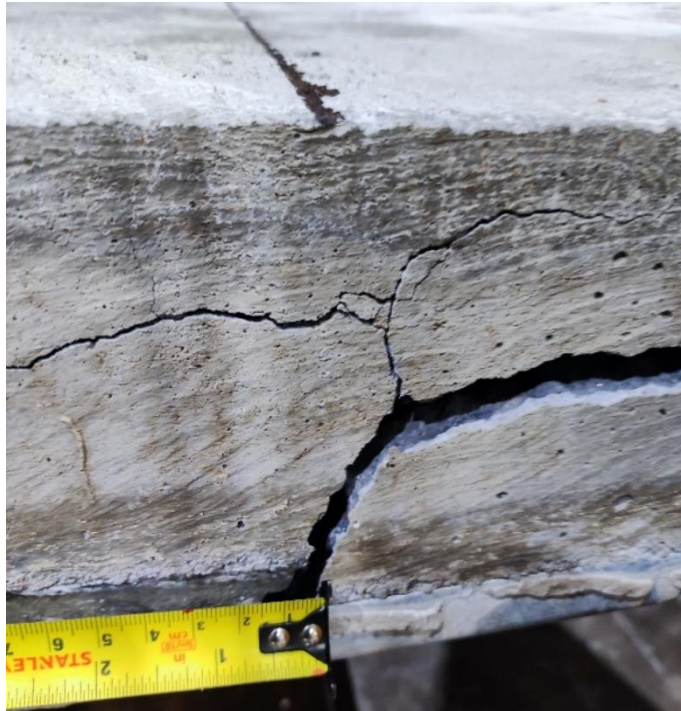
Figura 2.14. Desplazamiento encontrado en la probeta
