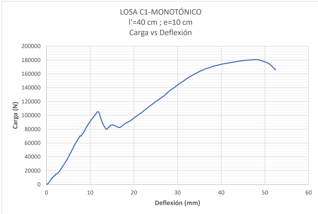
Figura 3.2. Esfuerzo deformación probeta C1.
