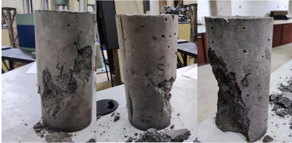
Figura 2.7. Cilindros después del ensayo de compresión
