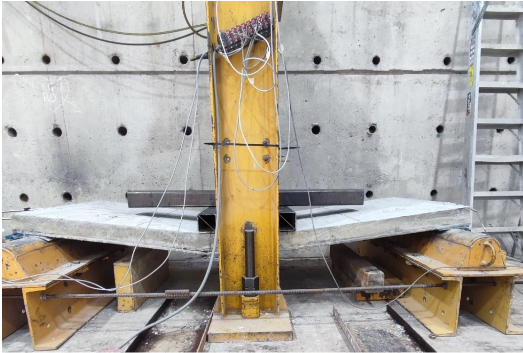
Figura 2.13. Aplicación de la fuerza sobre la probeta
