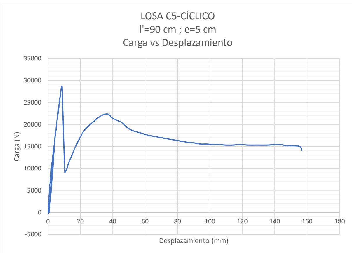
Figura 3.13. Esfuerzo deformación probeta C5.
