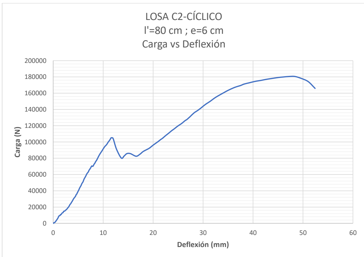
Figura 3.10. Esfuerzo deformación probeta C2.
