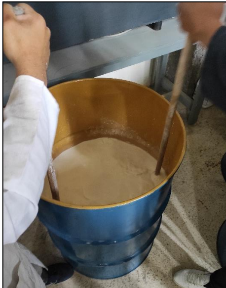
Figura 2.10 Mezclado de la cal.
