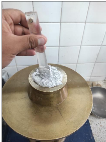
Figura 2.20 Apisonamiento para determinación del flujo. Elaborado por: Jonathan Villa
