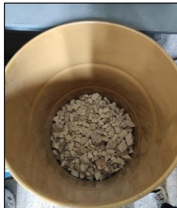
Figura 2.8 Preparación de cal para el apagado.
