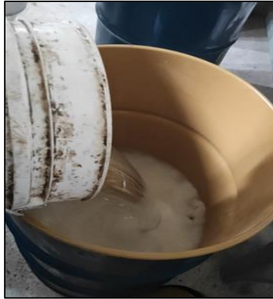
Figura 2.9 Vertido de agua en la cal.
