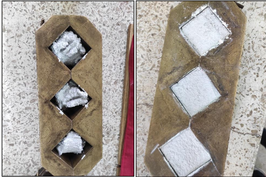
Figura 2.23 Moldeado de los morteros
