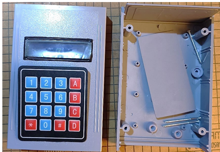
Figura 3.63 Caja contenedora del circuito
