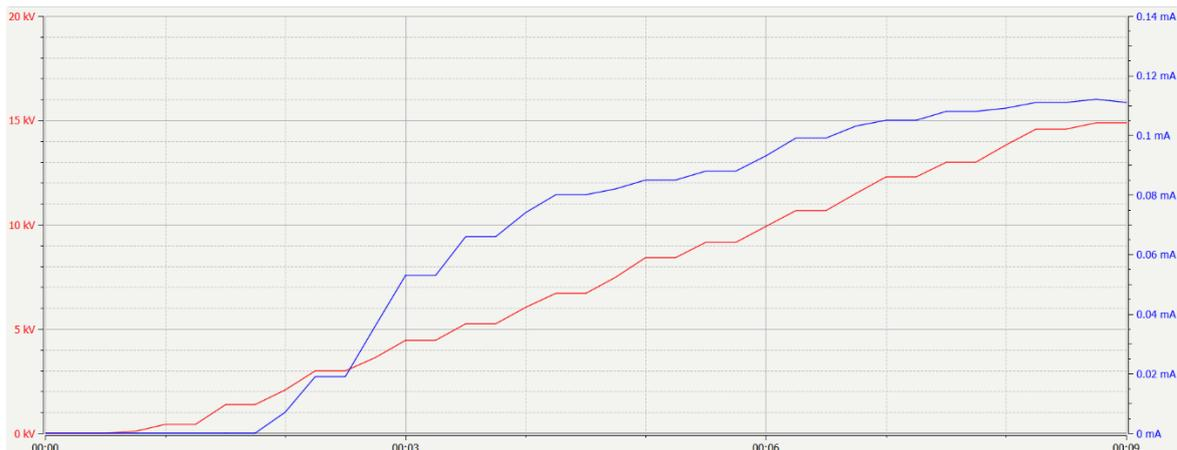
**Figura 29.** Trazas de voltaje aplicado y corriente de fuga en prueba con CC.
