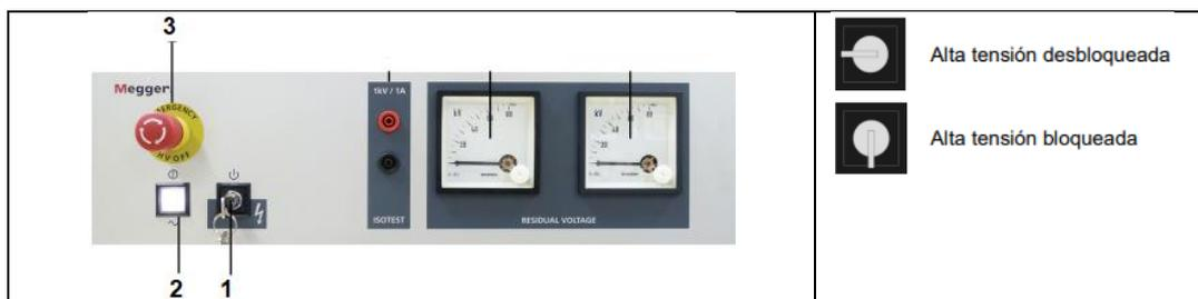
**Figura 5.** Panel de elementos de control e indicadores.
