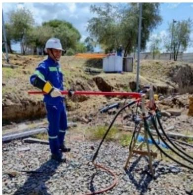
**Figura 2.7.** Desenergización de cables posterior a inyección de tensión de prueba. Estas pautas son aplicadas en cada prueba descrita en este documento. Además, dichas pautas son consideradas para la estructuración de la guía y anexadas en la Guía Técnica.
