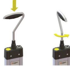
1. Conectar clavija del receptor.
