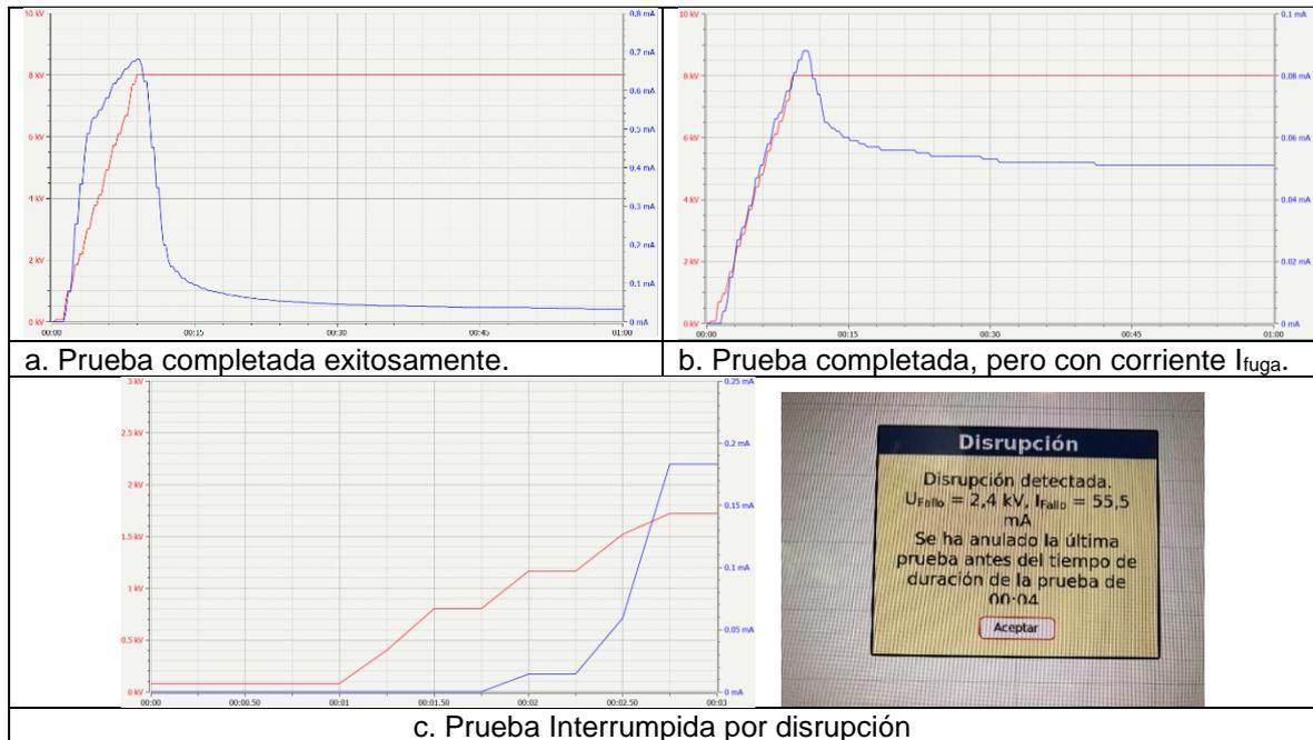
**Figura 2.12.** Gráficas de resultantes de prueba de cubierta.
