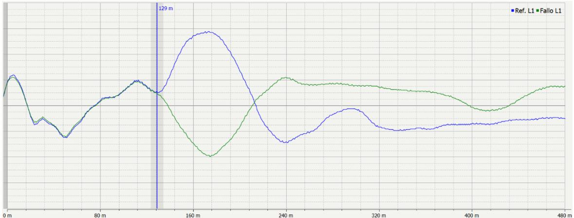
**Figura 33.** Traza de falla superpuesta al reflectograma de referencia con disparo ajustado.
