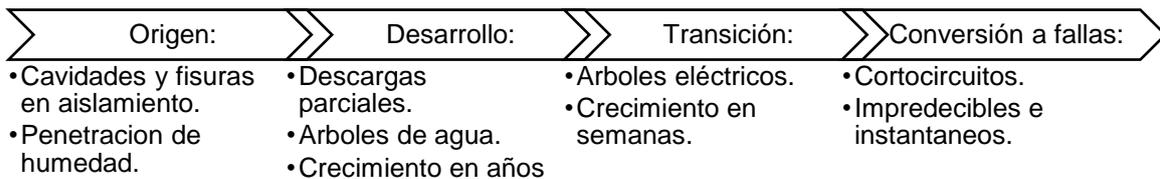
**Figura 1.10.** Proceso de degradación de aislamiento extruido en cables [15].
