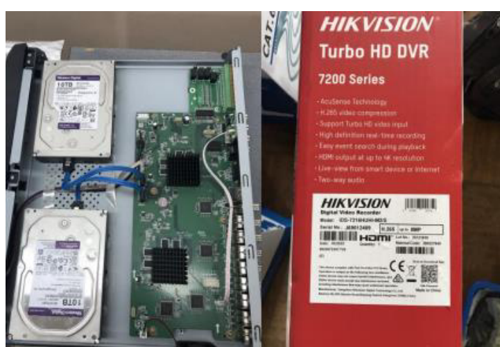
Figura 2.3.HDD para almacenamiento de cinta - EPN [1].
