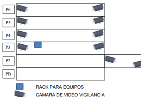
Figura 2.2. Plano de posicionamiento de cámaras - EPN [1].
