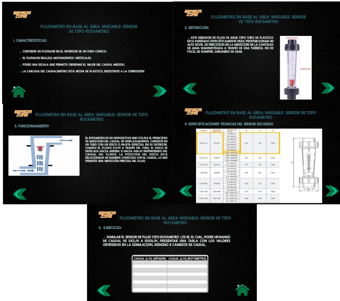
Figura 36. Escenas con información del sensor de flujo tipo rotámetro
