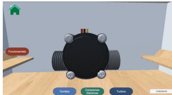
Figura 26. Escena para observar la estructura del sensor
