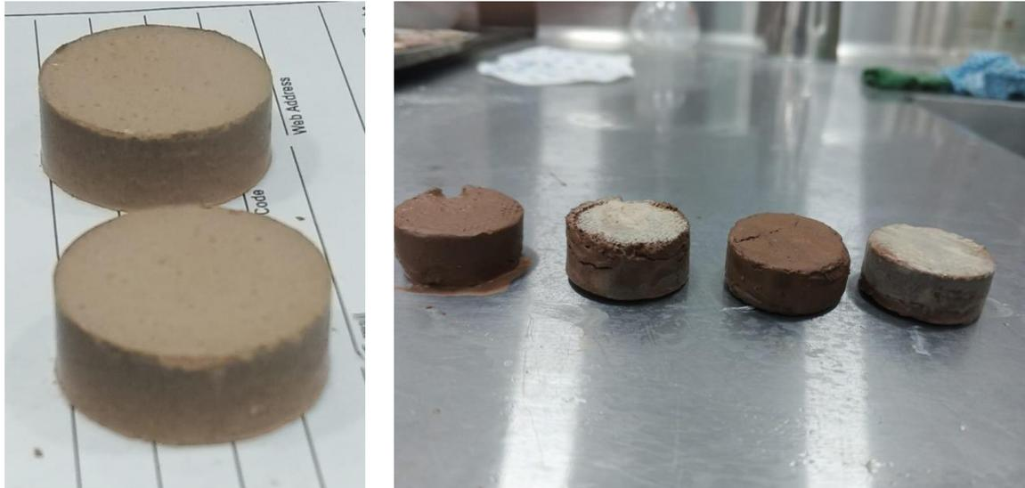
**Figura 19.** *Pastillas antes y después de las pruebas de hinchamiento lineal*
