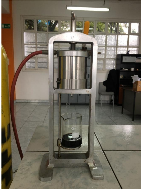
Figura 9. Filtrado de la mezcla en la prensa API. Modificado por Núñez (2023)
