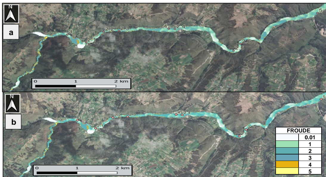
Figura 83. Froude tramo 2, t = 2040s : (a) escenario 1A y (b) escenario 2A.
