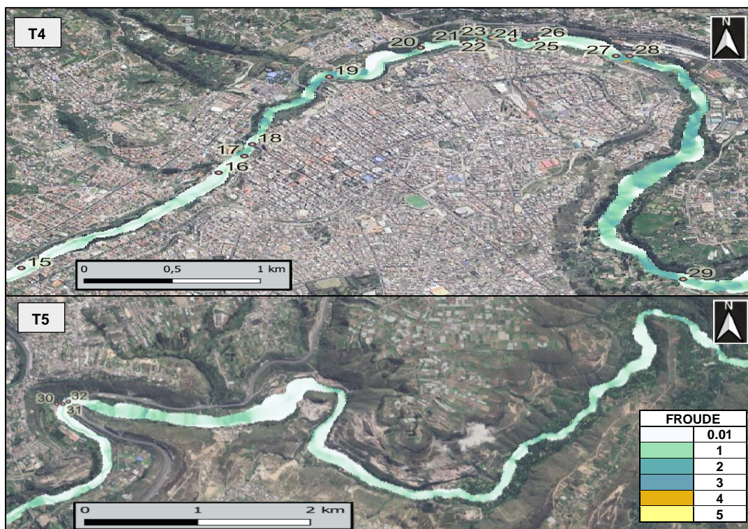
Figura 41. Froude tramo 4 y 5 para los tiempos (a) 4800s y (b) +9300s. Fuente: Paulina Suárez
