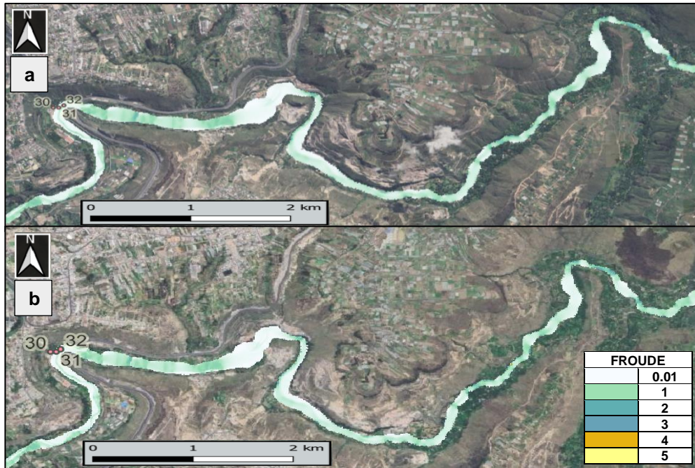
Figura 86. Froude tramo 5, t = 9300 s: (a) escenario 1A y (b) escenario 2A.
