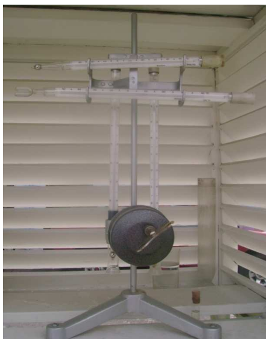
Figura 2.16 Termómetros de máxima y mínima utilizados en el INHAMI.
