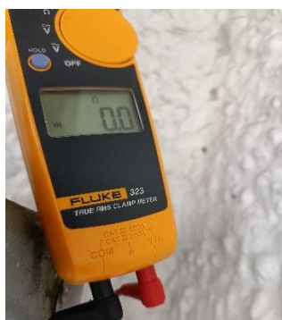
Figura 2.13 Continuidad en el fusible.
