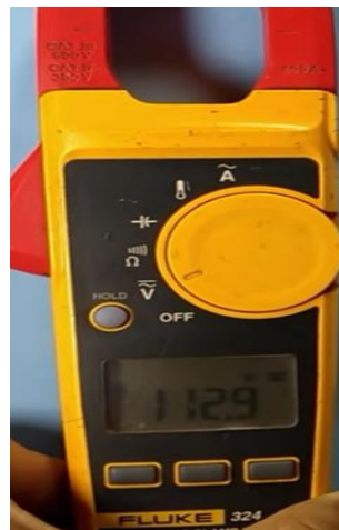
Figura 2.16 Medición de voltaje de fase.
