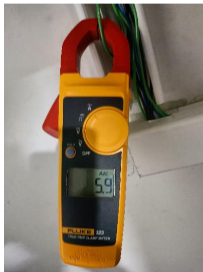
Figura 2.15 Corriente nominal en el circuito de control.
