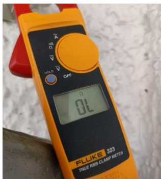
Figura 2.12 Medición de continuidad.
