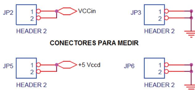
Figura 2.9 Puntos de prueba para medir voltajes.
