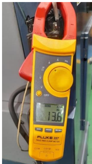
Fig. 2.15: Medición del amperaje de la probeta V3F1A2-M. Fuente: Propia
