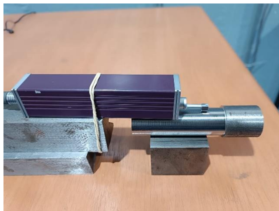
Fig. 2.22: Medición de rugosidad de la superficie cilindrada con rugosímetro en posición. Fuente: Propia
