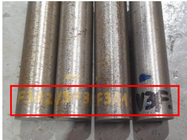
Fig. 2.10: Codificación colocada en las probetas a maquinar. Fuente: Propia
