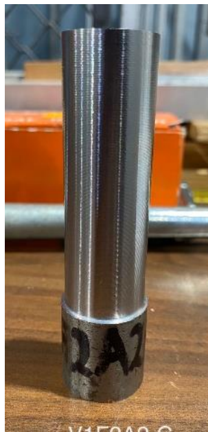
Fig. 3.30: Probeta con las mejores condiciones de redondez (V1F2A2-C). Fuente: Propia
