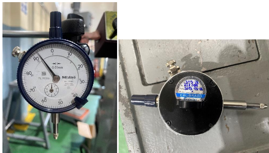
Fig. 1.11: Reloj comparador Mitutoyo con certificación de calibración EPN. Fuente: Propia
