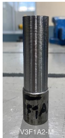
Fig. 3.12: Probeta con las mejores condiciones de conicidad (V3F1A2-M). Fuente: Propia
