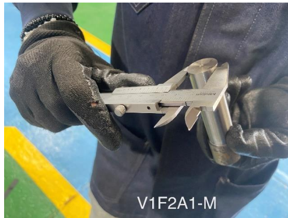
Fig. 2.21: Ejemplo de medición de diámetro final en la probeta V1F2A1-M. Fuente: Propia
