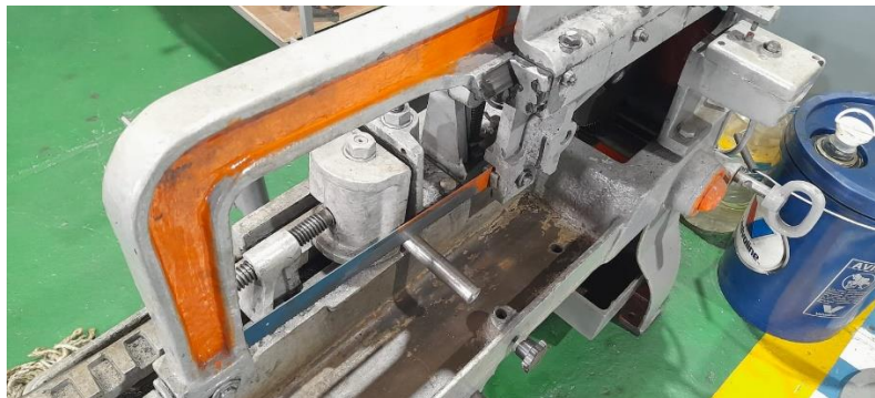
Fig. 2.8: Corte de 60 probetas a 100 [mm]. Fuente: Propia
