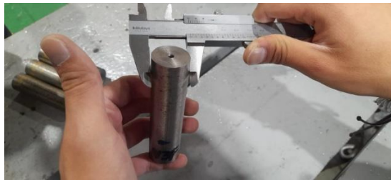
Fig. 2.12: Medición del diámetro inicial de las probetas. Fuente: Propia
