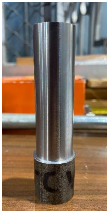
Fig. 3.26: Probeta con las mejores condiciones de conicidad (V2F3A1-C). Fuente: Propia
