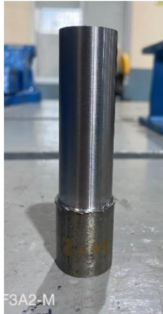
Fig. 3.8: Probeta con el mejor acabado superficial (V3F3A2-M). Fuente: Propia
