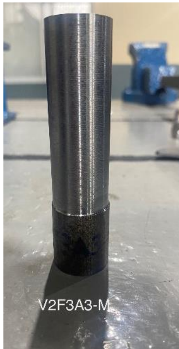
Fig. 3.16: Probeta con las mejores condiciones de redondez (V2F3A3-M). Fuente: Propia
