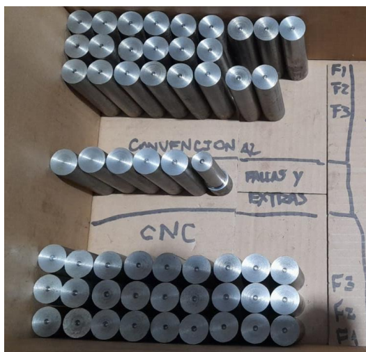
Fig. 2.9: Probetas pre refrentadas y con agujero guía de contrapunto listas para la experimentación. Fuente: Propia
