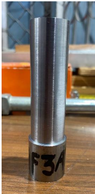
Fig. 3.22: Probeta con el mejor acabado superficial (V1F3A1-C). Fuente: Propia
