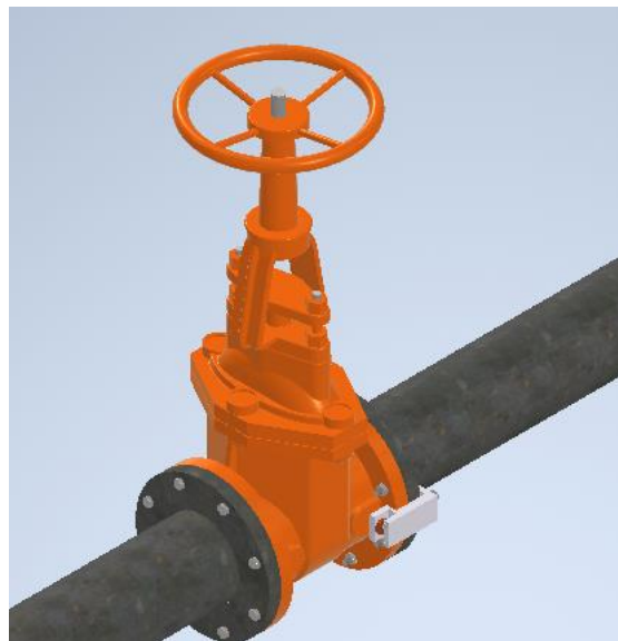
Figura 2.9, Montaje del generador electromagnético en la válvula de control. (Fuente Propia)
