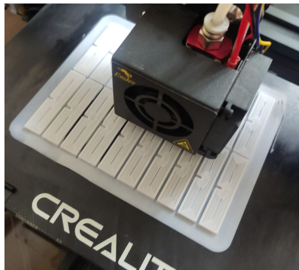
Figura 2. 14 Impresión de probetas en lote. [Fuente: propia]
