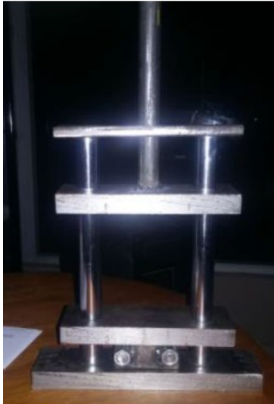
Figura 2. 19 Mecanismo para inserción de pre-grieta [30]
