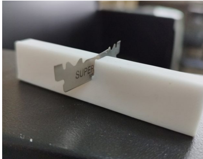
Figura 1. 10 Inserción manual de pre-grieta [Fuente: propia]
