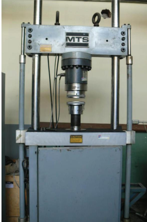
Figura 1.21. Sistema axial – torsional marca MTS con capacidad para 195 KN [44.000 lbs].
