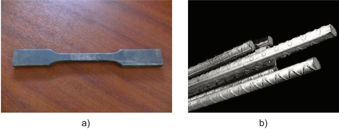
**Figura 1.23. Probeta plana de sección rectangular reducida (a) y probetas de sección transversal circular (b) para ensayo de tracción.**
