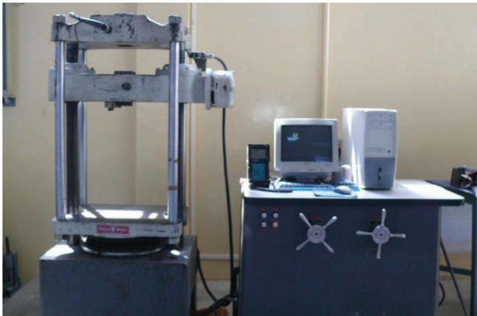
Figura 1.18. Máquina hidráulica universal de ensayos marca Tinius Olsen modelo súper L con capacidad para 587 KN [132.000 lbs].
