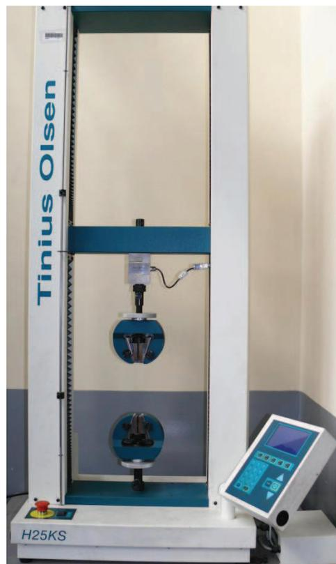
Figura 1.20. Máquina electromecánica universal de ensayos marca Tinius Olsen con capacidad para 25 KN [5.620 lbs].
