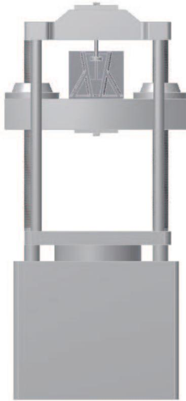
**Figura 4.7. Conjunto para prueba de liberación de probeta montado en la máquina universal de ensayos.**
