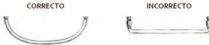
Figura 4.13. Criterio de radio de curvatura adecuada de una manguera hidráulica.
