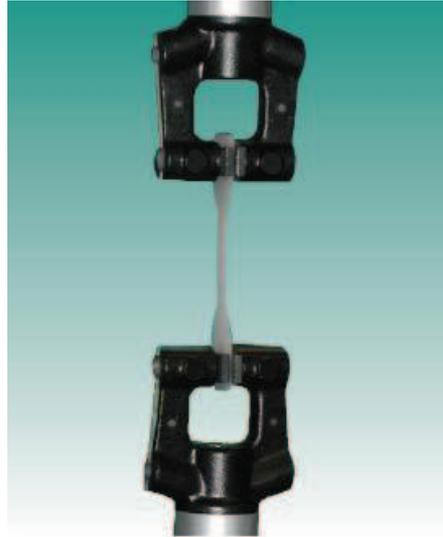
Figura 1.27. Sistema de mordazas neumáticas de cilindro interno y acción lateral<sup>22</sup>.
