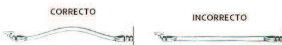
Figura 4.12. Criterio de longitud adecuada de una manguera hidráulica.
