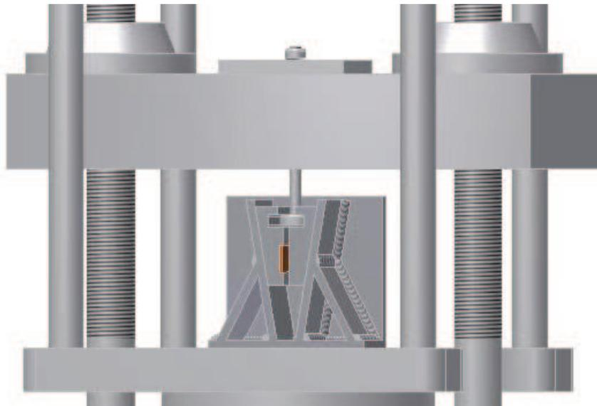
Figura 4.6. Prueba de sujeción de probeta en el marco de compresión de la máquina universal.
