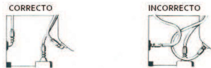
Figura 4.14. Criterio de instalación adecuada de mangueras hidráulicas.
