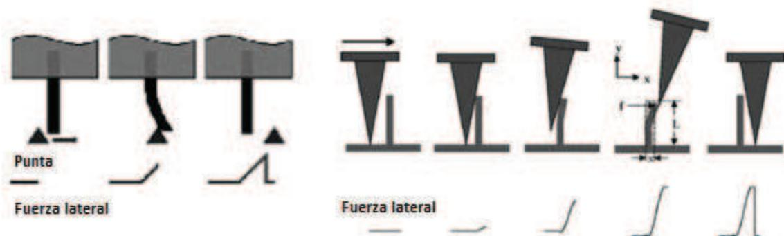
Figura 1.4. Ensayo de microscopía de fuerza lateral LFM<sup>6</sup>.
