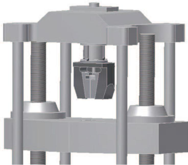
**Figura 4.10.** Mordaza hidráulica de sujeción montada en el marco de tracción de la máquina universal de ensayos.
