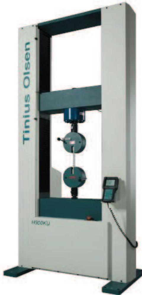
Figura 1.17. Máquina electromecánica universal de ensayos<sup>19</sup>.
