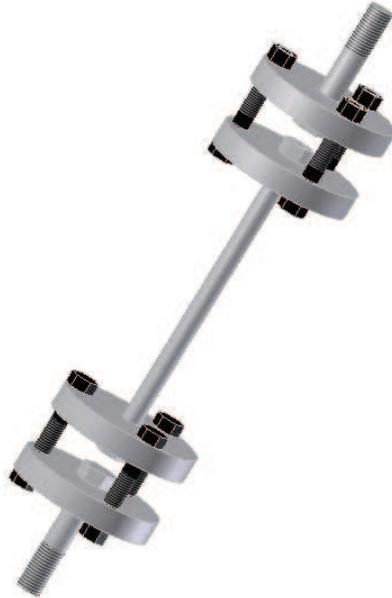
Figura 4.9. Conjunto para ensayo de pernos y ejes en la máquina universal de ensayos.
