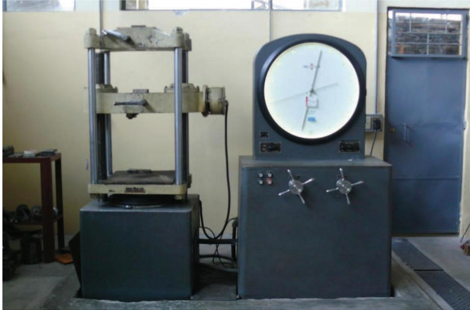
Figura 1.19. Máquina hidráulica universal de ensayos marca Tinius Olsen modelo súper L con capacidad para 534 KN [120.000 lbs].
