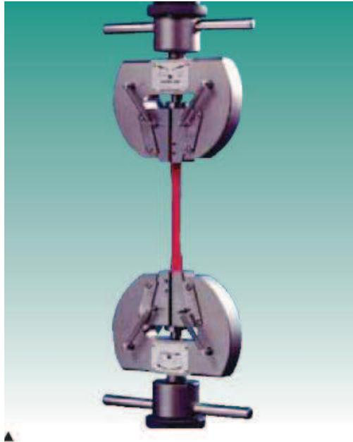
Figura 1.22. Sistema de sujeción para una máquina universal de ensayos<sup>20</sup>.
