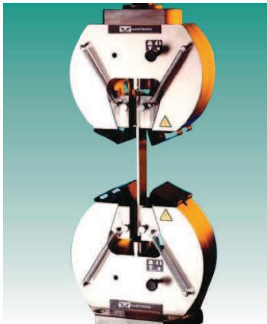
Figura 1.26. Sistema neumático de sujeción basado en el efecto cuña<sup>21</sup>.
