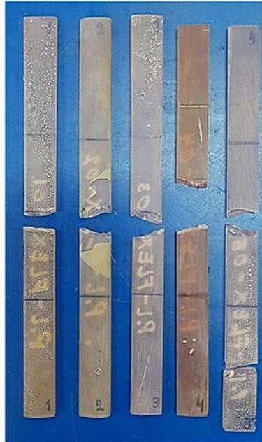
Figura A3. Probetas del grupo "PL-FLEX" después de los ensayos de flexión.
