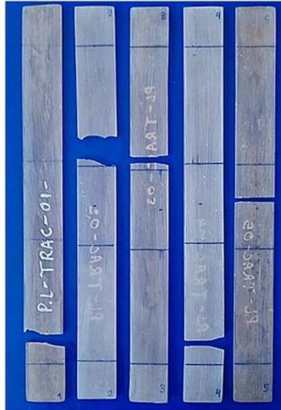
Figura A1. Probetas del grupo "PL-TRAC" después de los ensayos de tracción.
