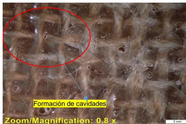
Figura 68 Micrografía de probeta 27 después del ensayo de impacto
