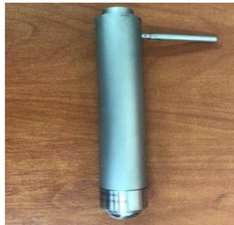
Figura 28 Dardo para ensayo de impacto
