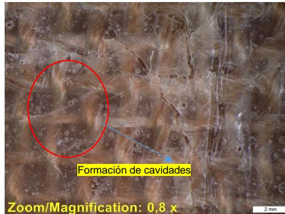
Figura 70 Micrografía de probeta 29 después del ensayo de impacto
