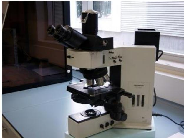
Figura 11 Microscopio óptico, Olympus BX60
