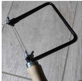
Figura 21 Caladora para corte de material compuesto
