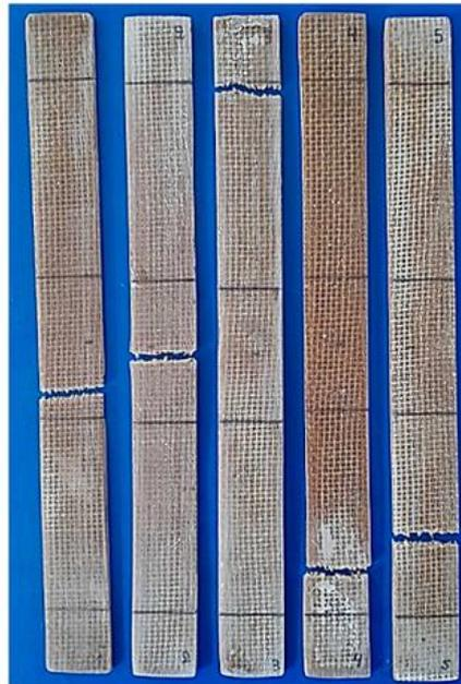
Figura A2. Probetas del grupo "PL-TRAC-COMP" después de los ensayos de tracción.
