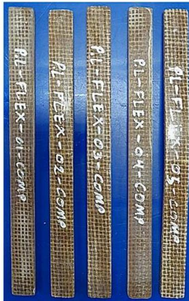
Figura A4. Probetas del grupo "PL-FLEX-COMP" después de los ensayos de flexión.
