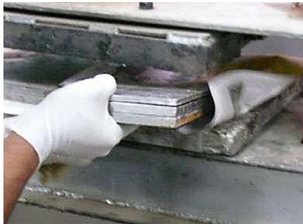
Figura 36 Aplicación de cargas con prensa hidráulica
