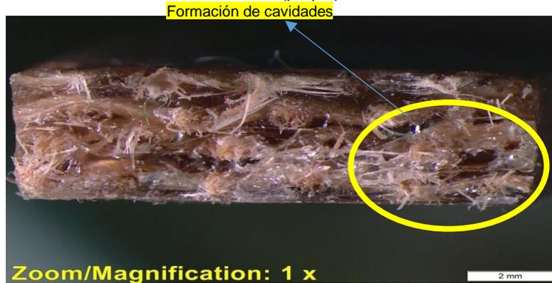
Figura 64 Micrografía de probeta 2 después del ensayo de flexión
