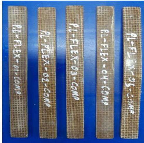
Figura 51 Probetas de material compuesto después de realizar el ensayo de flexión
