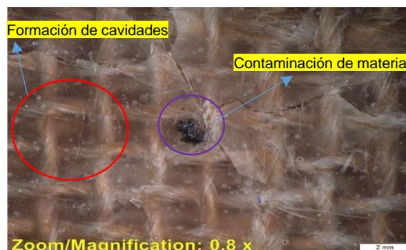
Figura 69 Micrografía de probeta 28 después del ensayo de impacto
