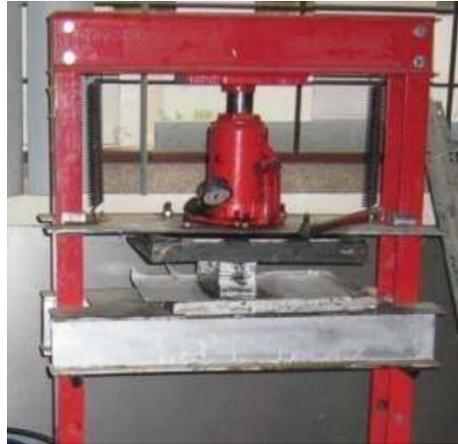
Figura 23 Prensa hidráulica manual
