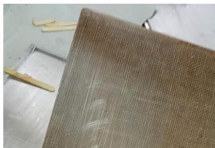
Figura 37 Desmolde del material compuesto solidificado
