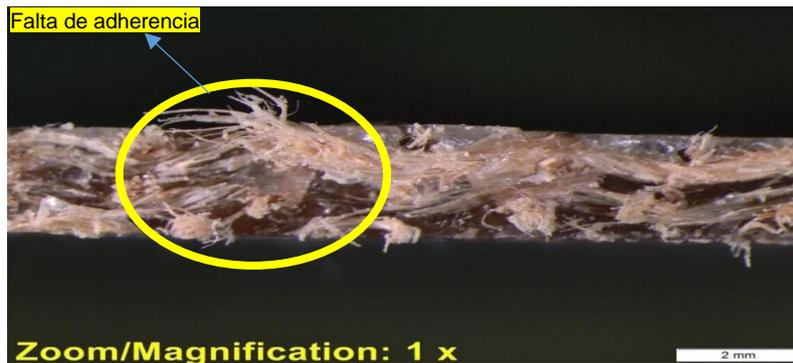
Figura 62 Micrografía de probeta 5 después del ensayo de tracción
