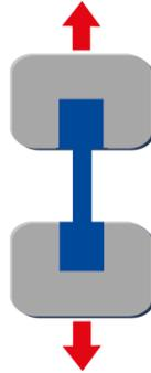
Figura 8 Esquema del proceso de tracción de un material
