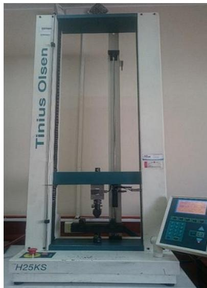
Figura 24 Máquina de ensayo universal
