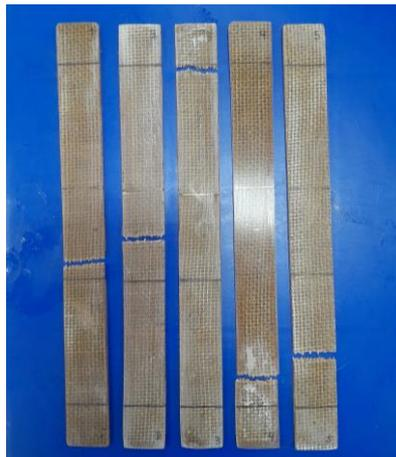
Figura 44 Probetas de material compuesto después de ensayo normalizado de tracción
