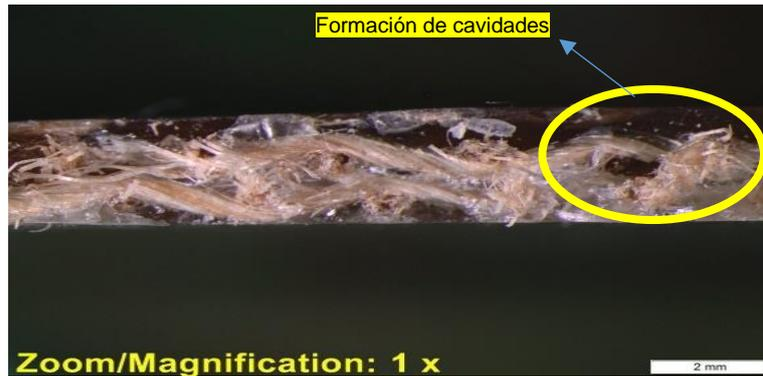
Figura 58 Micrografía de probeta 1 después del ensayo de tracción
