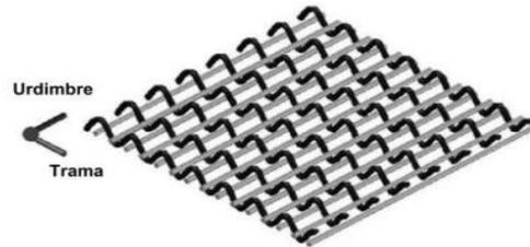
Figura 6 Esquema fundamental de un tejido
