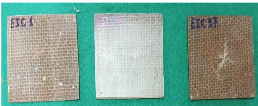
Figura 57 Probetas de material compuesto después de realizar los ensayos de impacto
