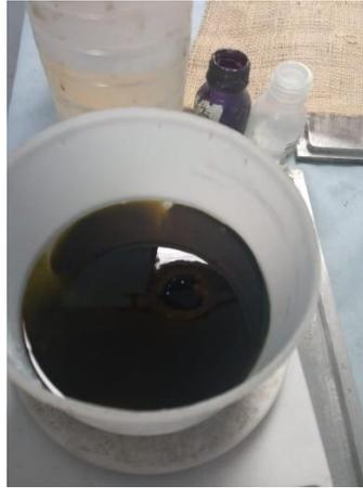
Figura 33 Mezcla de resina con aditivos
