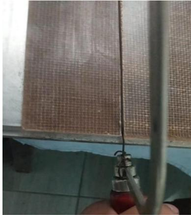
Figura 38 Corte de planchas de material compuesto
