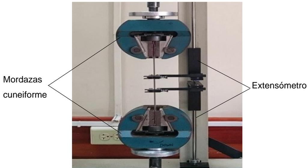
Figura 25 Mecanismo de tracción
