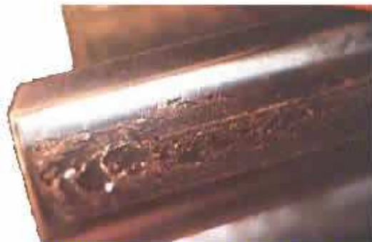
Figura 2.15 Desgaste por cavitación
