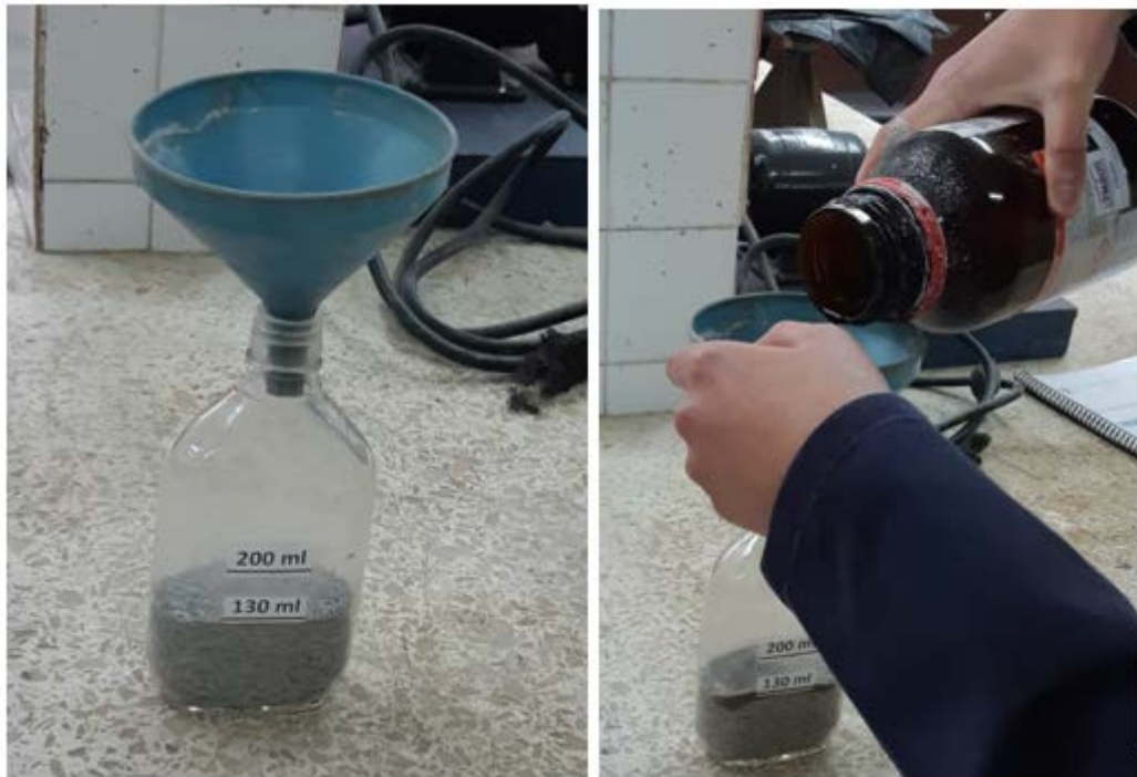
Figura 12 Proceso de Ensayo de Contenido Orgánico
