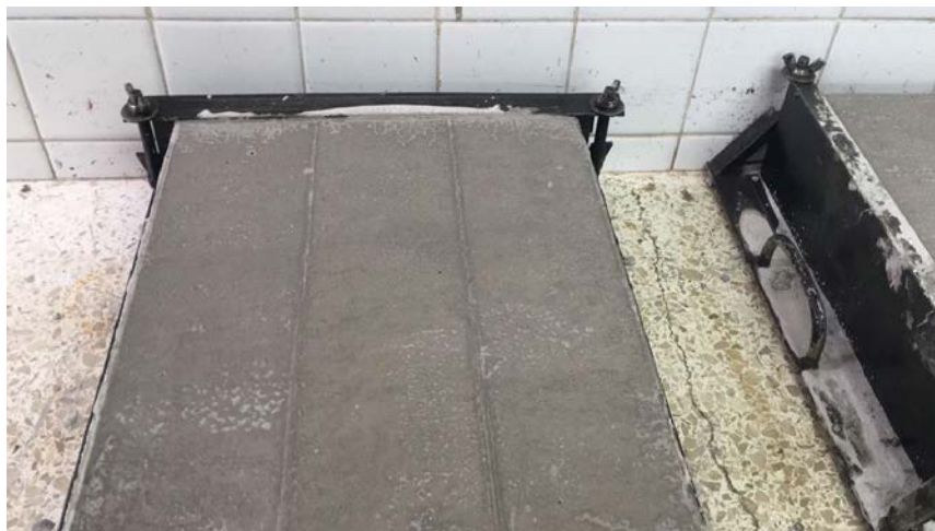
Figura 34 Vigas Previo a desmoldarse
