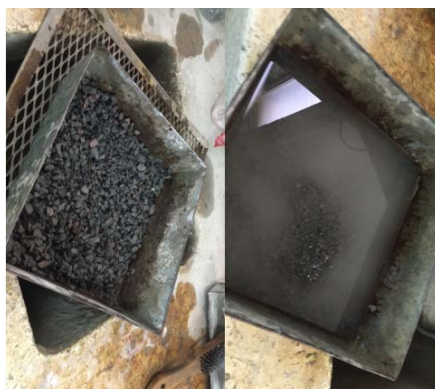
Figura 7 Proceso de ensayo de Densidad y Absorción
