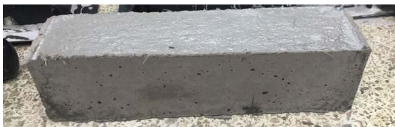
Figura 35 Viga previo a Ensayarse
