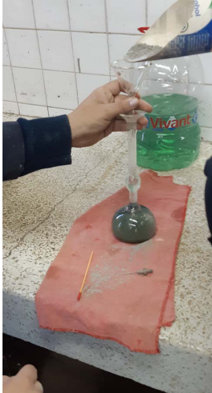
Figura 13 Parte del proceso de ensayo de densidad real del cemento
