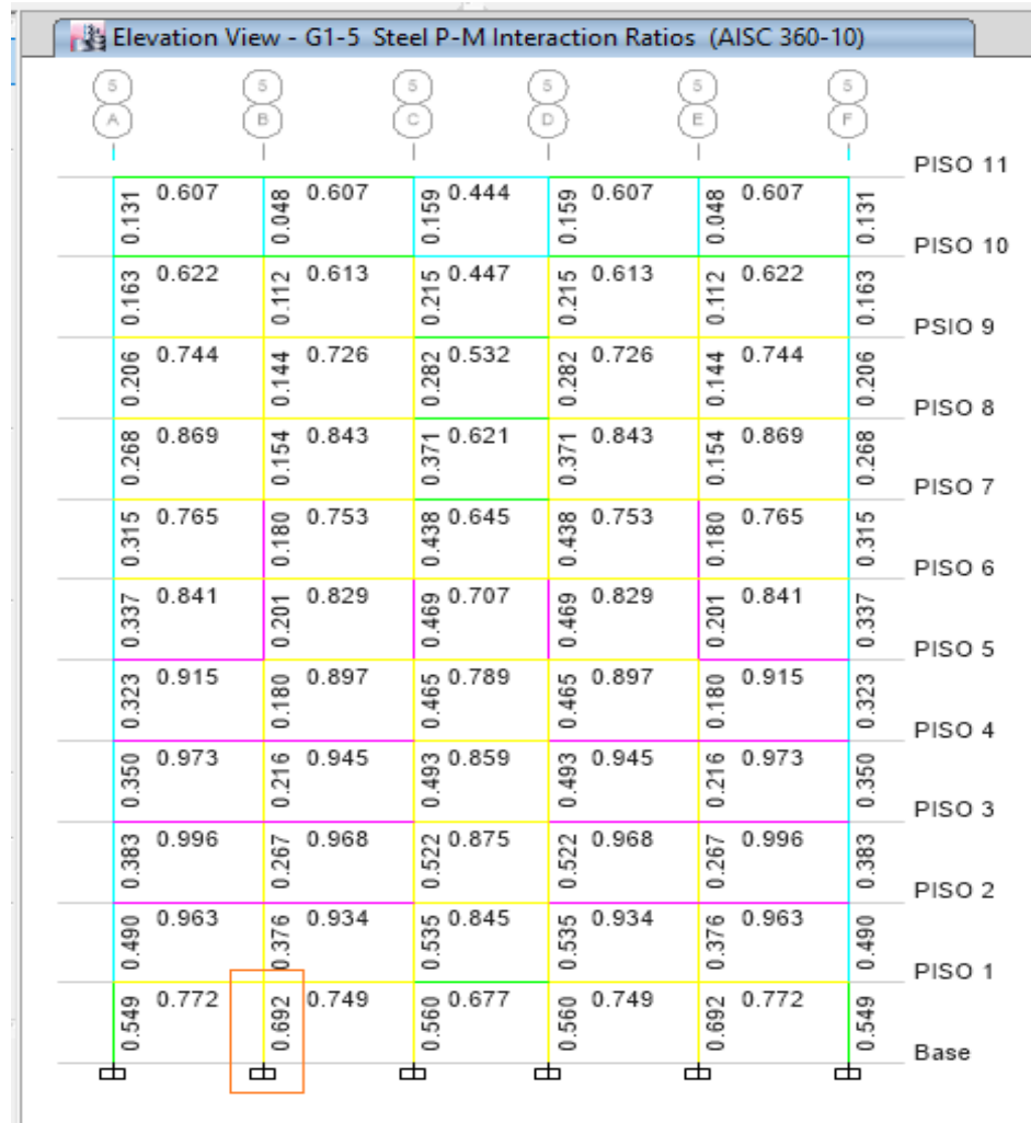
Figura 2.23. Relación demanda/capacidad en columnas – Edificio 11 pisos
