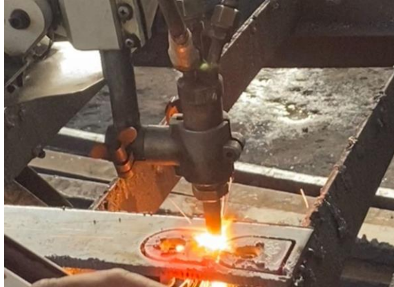
Figura 2.16 Proceso de oxicorte para fabricación del componente
