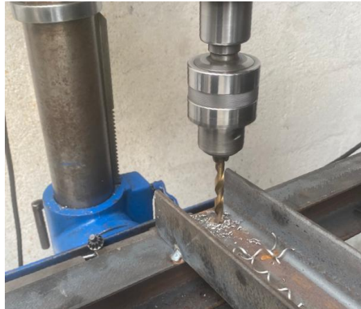
Figura 2.14 Perforación de los perfiles para pernos de 8 (mm)
