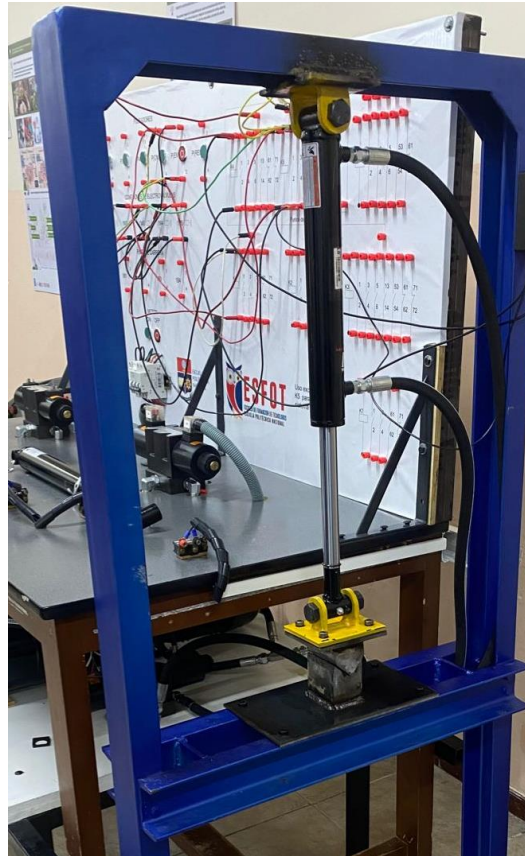
Figura 2.21 Pistón hidráulico y matriz ensamblados
