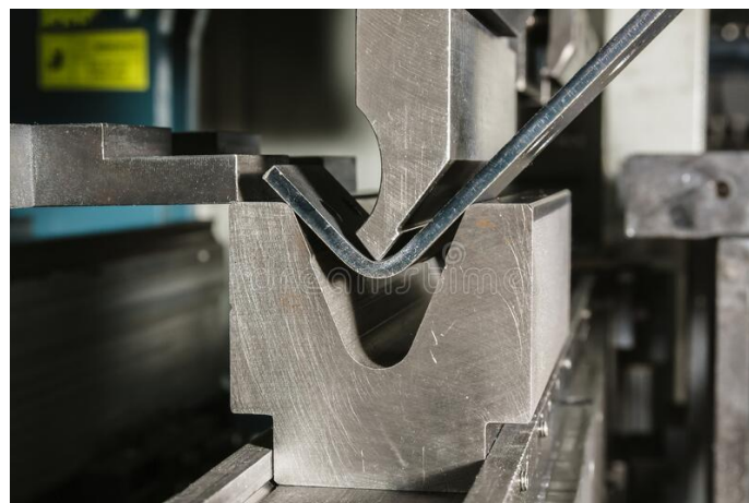
Figura 1.9 Proceso de doblado, [18]
