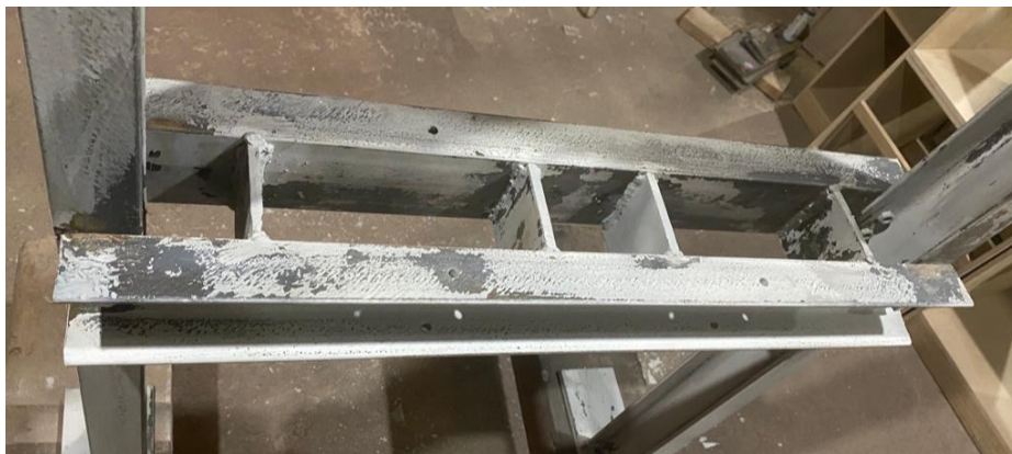
Figura 2.15 Mesa de la prensa hidráulica en proceso de pintado
