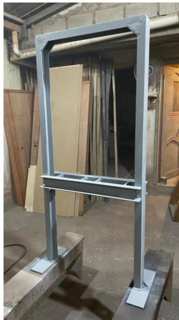
Figura 2.20 Estructura principal de la prensa terminada
