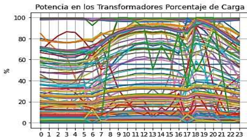
Figura 3.1.2.6. Flujo de potencia activa en los transformadores, en porcentaje. SNI ecuatoriano.
