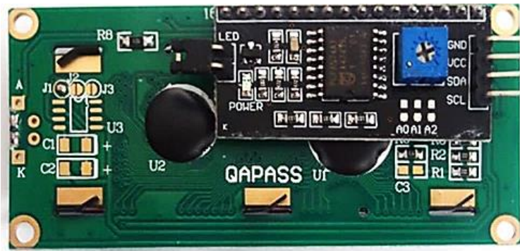
Figura 2.15. Conexión LCD y Módulo I2C
