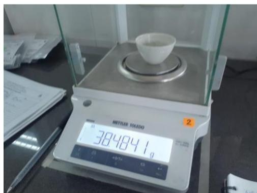
**Figura 11.** Medición de crisol sólidos suspendidos
