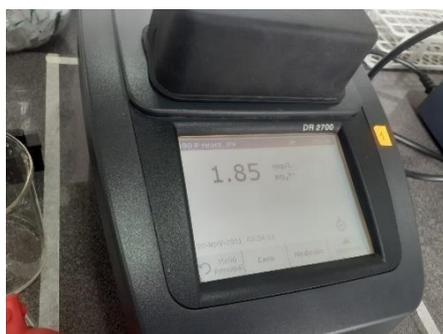
**Figura 17.** Medición de Fosfatos.
