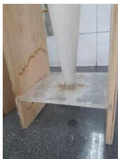
**Figura 13.** Medición de sólidos sedimentables.
