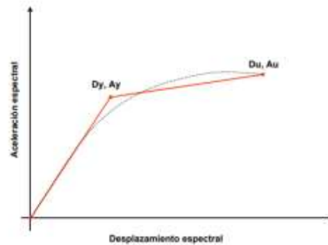
Figura 6 Representación bilineal de la curva de capacidad
