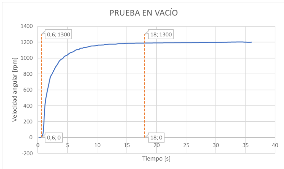
Figura 81. Prueba en vacío de la turbina y regulador de velocidad
