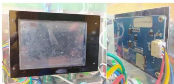
Figura 22. Conexión de la pantalla nextion dentro del GOV [3]
