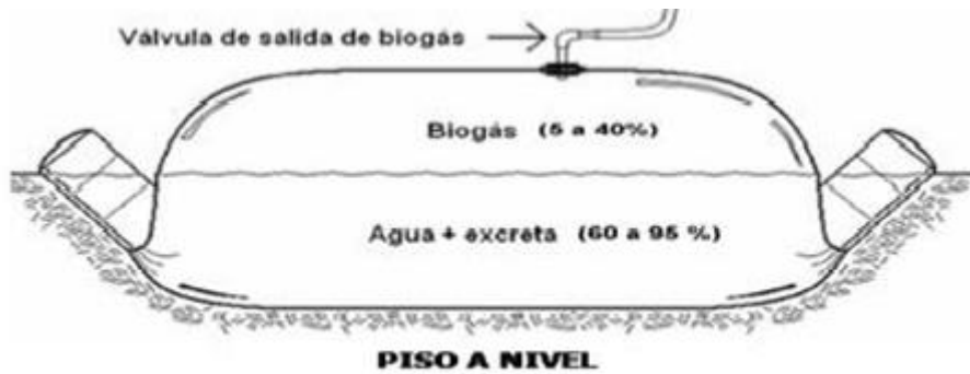
Figura 20. Biodigestor de estructura flexible. [34]
